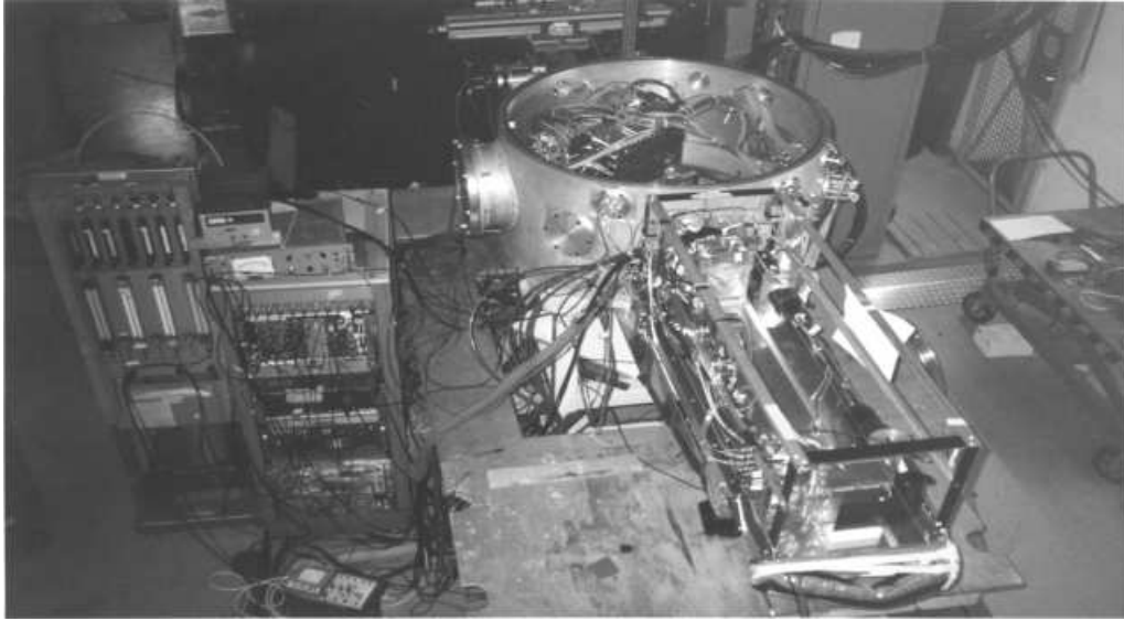
FIG. 7.1: Vue d'ensemble de l'expérience à GSI. La matrice est visible dans la chambre à diffusion. Sur le bras, on peut distinguer une partie du télescope de scintillateurs et les chambres proportionnelles multifils.
