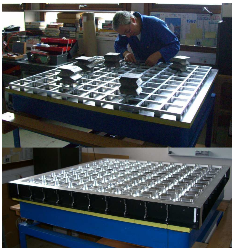
FIG. 2.11 – Photographies du montage du cadre inférieur. En haut, montage de la grille de support de module de photomultiplicateur sur un marbre. En bas, fin de la réalisation avec l'ajout des montants.
