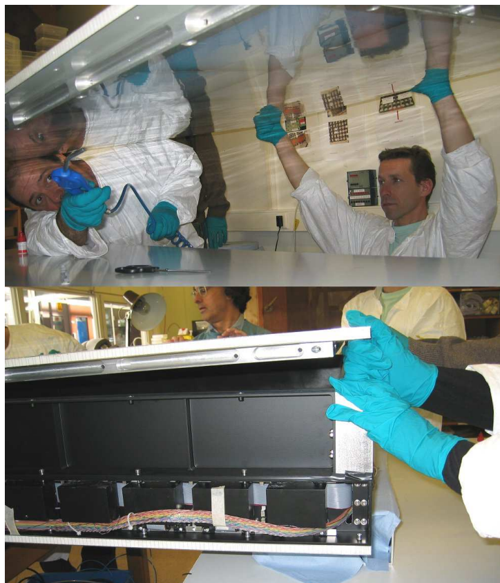
FIG. 3.11 – Photographies de l'intégration du plan radiateur dans le reste de CherCam déjà assemblé.
