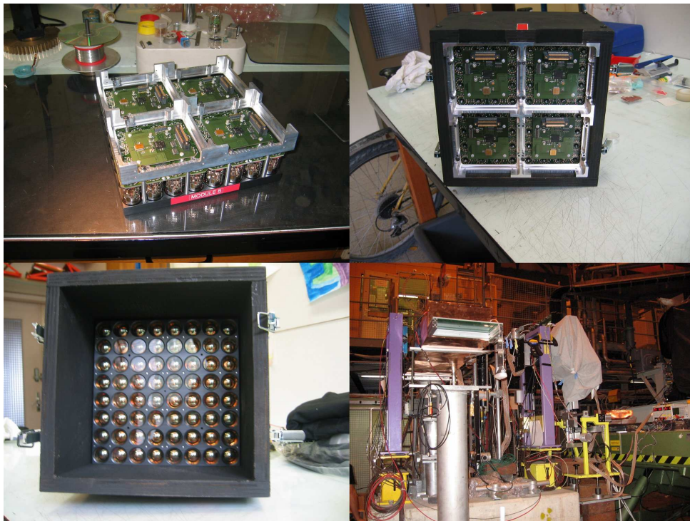
FIG. 5.1 – Photographies du prototype de CherCam. En haut, de gauche à droite, est présenté le module de photomultiplicateur utilisé pour le prototype avant et après son insertion dans le boîtier. En bas à gauche, on peut voir l'autre côté du boîtier où vient se fixer un couvercle soutenant un couple de tuiles d'aérogel. En bas à droite, le montage utilisé pour le faisceau test est photographié (le faisceau venant de la gauche). Sur le deuxième support violet sont fixés les SBT, suivis du prototype de CherCam recouvert d'un drap (utilisé pour parfaire à l'étanchéité lumineuse).
