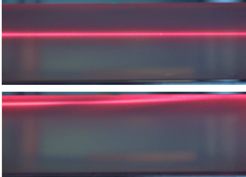
FIG. 3.4 – Photographie de l'observation de la traversée d'un faisceau laser dans toute la largeur d'une tuile d'aérogel de Novosibirsk. Dans le cas du haut, le laser traverse la tuile en son centre. En comparaison, le cas du bas, où le laser traverse la tuile à seulement quelques millimètres de sa surface. Dans les deux cas l'orientation du laser par rapport à la tuile n'est pas modifiée. On remarque dans le cas du bas une déviation du laser vers l'extérieur de la tuile dû à la présence de gradients d'indice.
