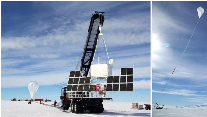
FIG. 4.2 – Photographie de CREAM pendant la préparation au lancement (à gauche) et pendant la phase de décollage (à droite).
