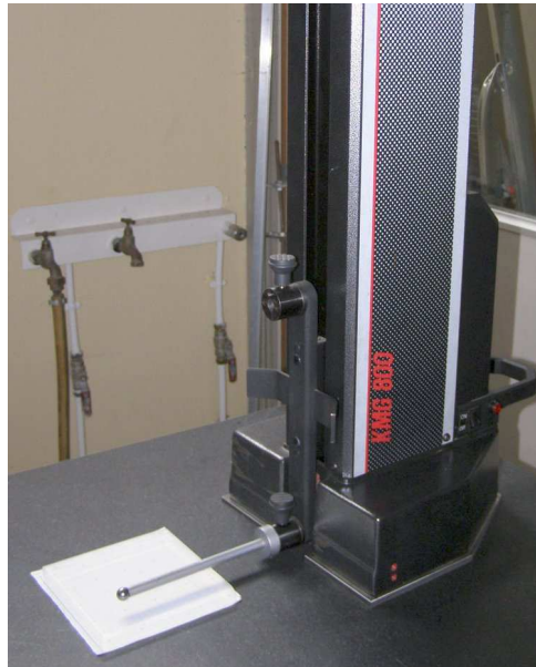
FIG. 4.3 – Photographie du comparateur mécanique lors de la mesure métrologique d'une tuile d'aérogel.
