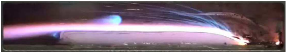
Figure 1.3 : Structure de la zone de combustion d'une paraffine (carburant liquéfiable). Le flux va de la droite vers la gauche. Illustration issue de la référence [13].
