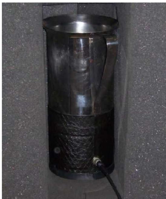
Figure 44 : Cuve à ultrasons de capacité 3 Litres
