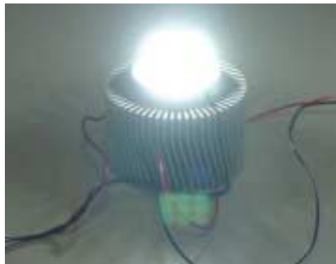
Figure 19 : Lampe blanche de CREE. Elle délivre 1200 lm pour 37,5W [9].
