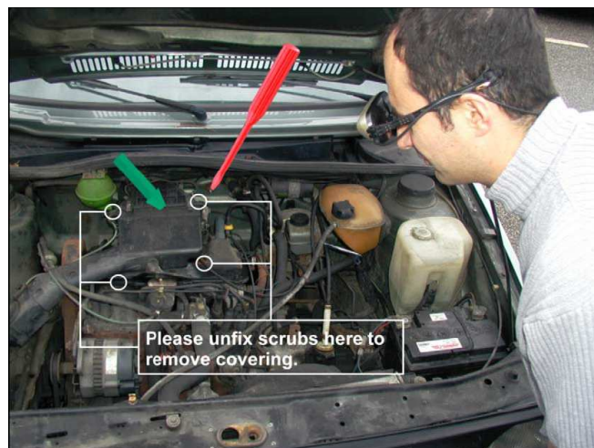
Fig. 1. Vue « augmentée » d'un système d'injection réel et des instructions de démontage virtuelles (d'après Dangelmaier et al. , 2005)
