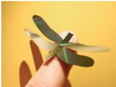
FIGURE 8.1 – Libellule artificielle de la société SilMach .
