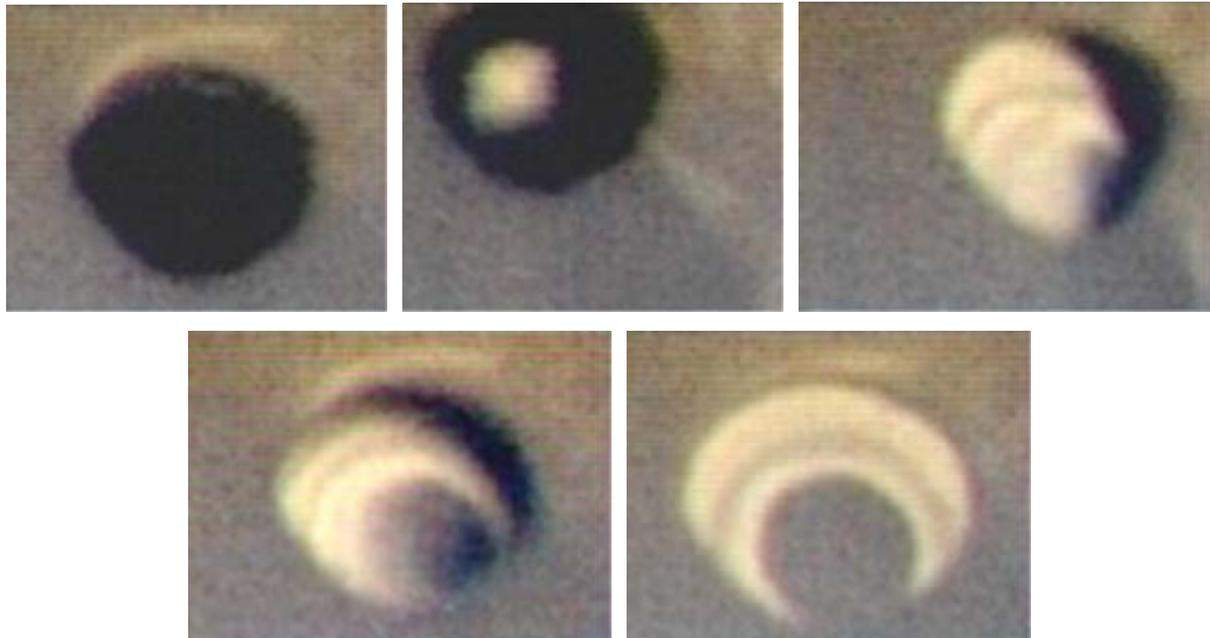
**Figure 3.19 :** Reconstitution de l'ouverture du film à partir de plusieurs séquences d'éclatement de bulles d'un diamètre équivalent moyen de 7,41 mm ; les images 1, 4 et 5 appartiennent à la même séquence [Huber (2000)]
