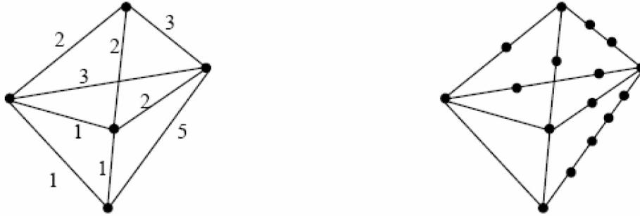
FIG. 4.92: Un graphe pondéré « transformé » en un graphe dont toutes les arêtes sont de longueur 1.
