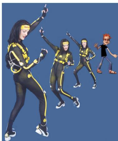
FIG. 1.18 – Système de capture électromagnétique : *MotionStar™* [Asc]
