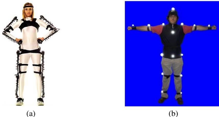
FIG. 1.19 – Systèmes de capture de mouvement : Système à armatures mécaniques *Gypsy5<sup>TM</sup>* [ani] (a) et système optique *MotionCaptor<sup>TM</sup>* [sim] (b).
