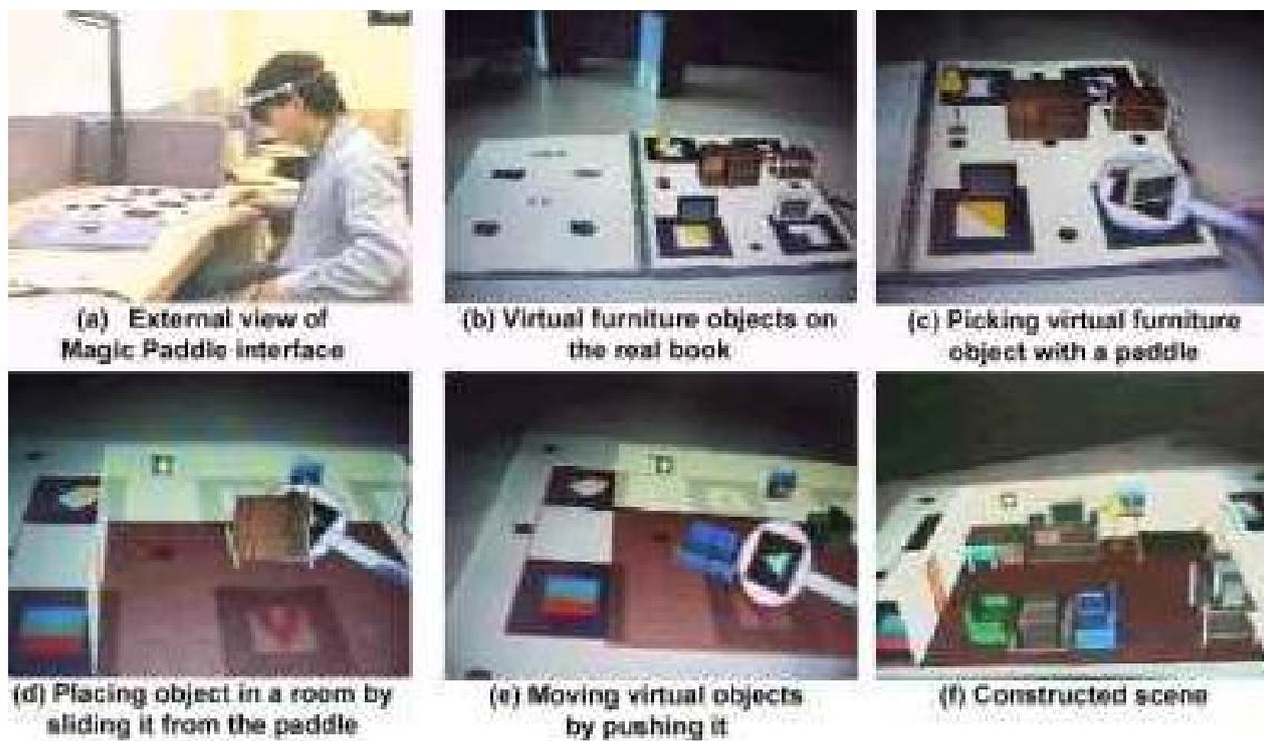
FIG. 1.29 – Utilisation d'interfaces tangibles pour la sélection/manipulation en RA : Le "Magic Paddle [DSD<sup>+</sup>02]".
