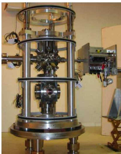
FIG. 5.1 : Photographie de la nouvelle enceinte à vide du gravimètre
