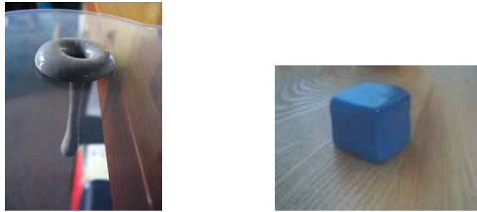
FIG. 1.7 – Silly-Putty sous forme liquide (à gauche) ; Silly-Putty sous forme solide (à droite). ©Fakr.
