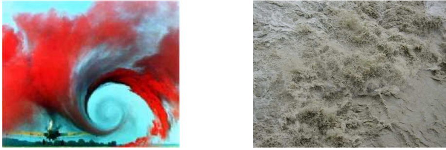
FIG. 1.10 – Visualisation des tourbillons de sillage consécutive au passage d'un avion léger à travers un panache de fumée. ©NASA Langley Research Center (à gauche); les torrents (à droite).
