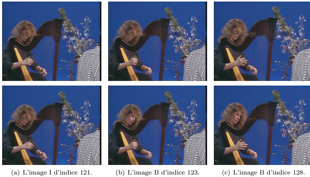
FIG. 7.13 – Comparaison des dégradations dans le cas d'un codage classique (haut) et d'un codage robuste (bas) pour les images de la figure 7.12.
