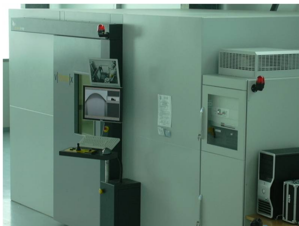
Figure A.8 – Appareil utilisé (référence : Phoenix v|tome|x L 240).
