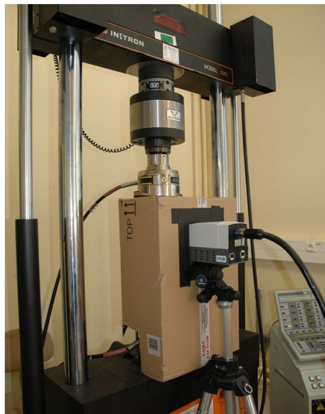
Figure 3.10 – Dispositif expérimental utilisé pour les mesures thermiques.
