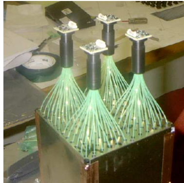
FIGURE 3.7 – Module d'EMCAL, avec les fibres de verre reliant les scintillateurs aux APD sur chaque tour [99].
