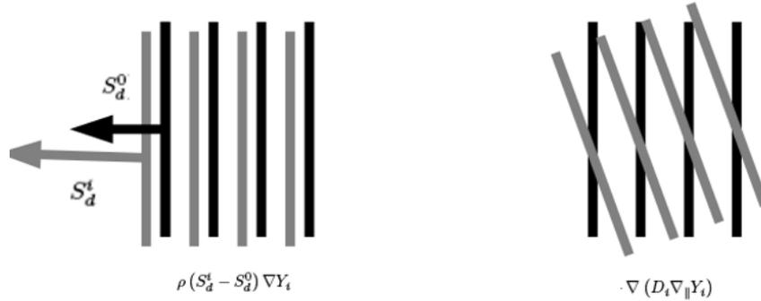
FIG. 2.12 – Effets des différentes contributions du terme  $\mathcal{Q}_i$  sur les iso-surfaces de  $c$  (en noir) et des  $Y_i$  (en gris) à travers une flamme de prémélange laminaire [155].
