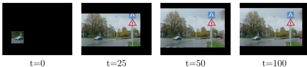
FIGURE 6.2.2: Exemple de recadrage dynamique simple. L'image est découverte progressivement, mais trop rapidement (un recadrage stable est obtenu dès t=50 , ensuite le système n'évolue quasiment plus). L'algorithme ne permet pas un parcours séquentiel des différents éléments saillants de l'image
