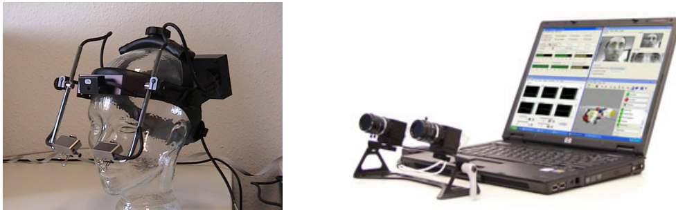
FIGURE 3.2.1: Deux dispositifs d'eye-tracking. A gauche une version « head-mounted ». A droite une version « desktop ».
