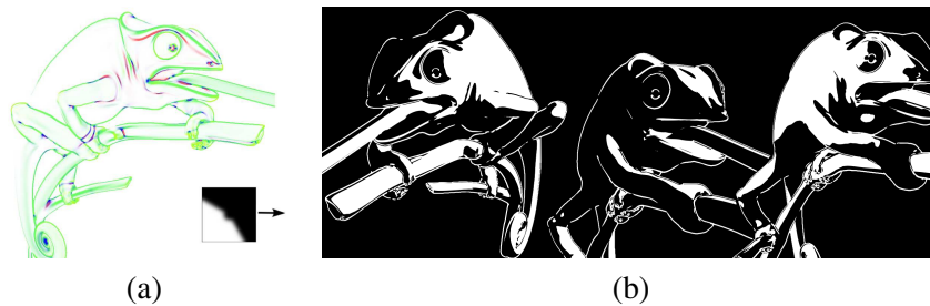
FIG. 5.6: Rendu minimal (0.15 M triangles / 250 fps). Le descripteur de forme (a) permet de réintroduire le contraste perdu lors de l'utilisation d'un style aussi simple. Les régions convexes apparaissent ici comme blanc sur noir ou noir sur blanc suivant la couleur de rendu d'origine. Pour la portion de gauche, l'objet est éclairé par la droite. Au centre, nous tournons l'objet pour montrer les zones dans l'ombre. La source de lumière est ensuite orientée vers la gauche pour obtenir le résultat de droite.
