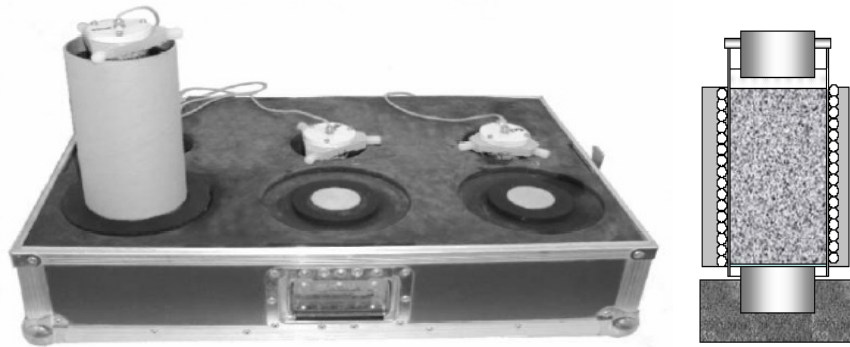
Figure 2-16 : BTPULS, dispositif de mesure aux ultrasons [STA08]
