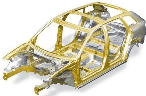
Figure 1.17 : Caisse d'un véhicule
