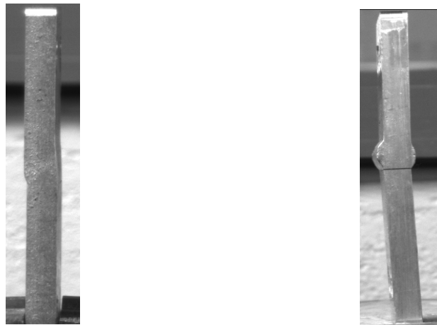
(a) avec soudure arasée
