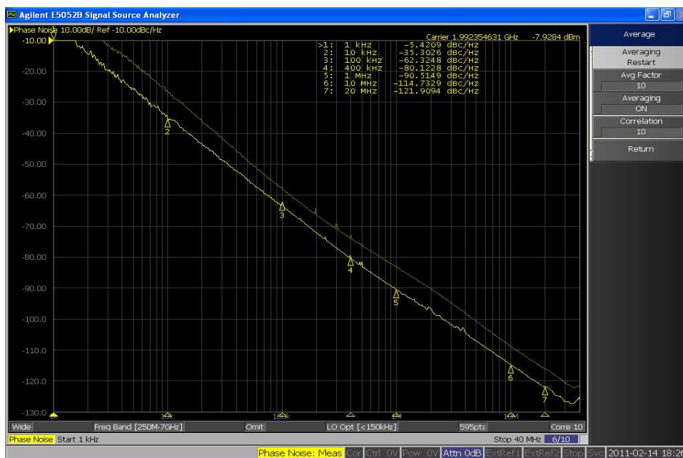
Figure 7-8 : Le bruit de phase dans les oscillateurs OSC_2T_1B et OSC_8T_4B
