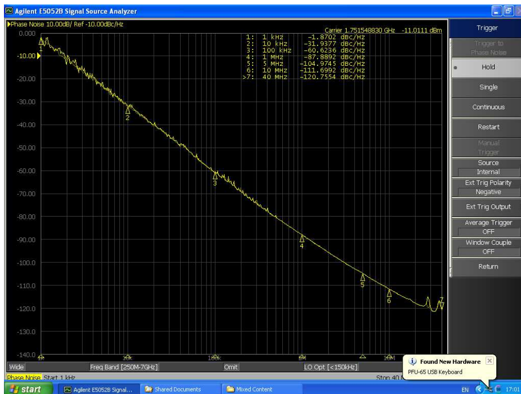
Figure 7-14 : Le bruit de phase dans l'oscillateur OSC_21_INV
