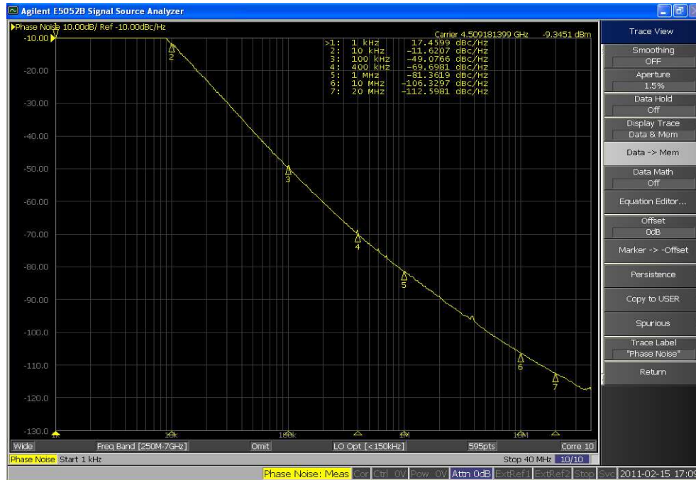
Figure 7-11 : Le bruit de phase dans l'oscillateur OSC_2T_3B_DYN
