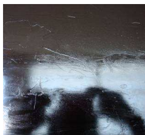
Figure IV-92: Pellicule formée après pulvérisation du produit de cure
