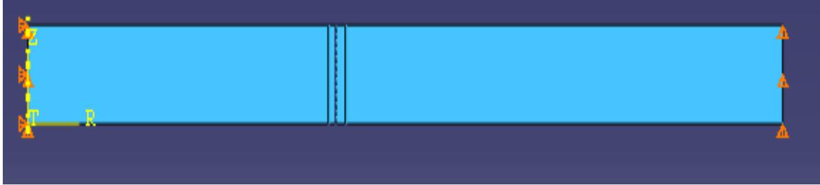
Figure.III.11 : Conditions aux limites du frettage avec axisymétrie
