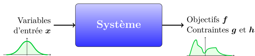
FIGURE 5.4 – Les incertitudes définies sur les entrées du système engendrent des incertitudes sur ses sorties.
