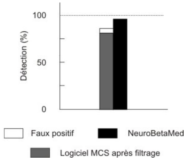
**Figure IV.17** – Détection on-line de PAs par l’intermédiaire de NeuroBetaMed\_XL (96 % de détection et 0% de faux positifs) et du logiciel MCS (80 % de détection et 5% de faux positifs) sur des signaux pancréatiques enregistrés à partir d’un MEA et sur une période de 5 minutes
