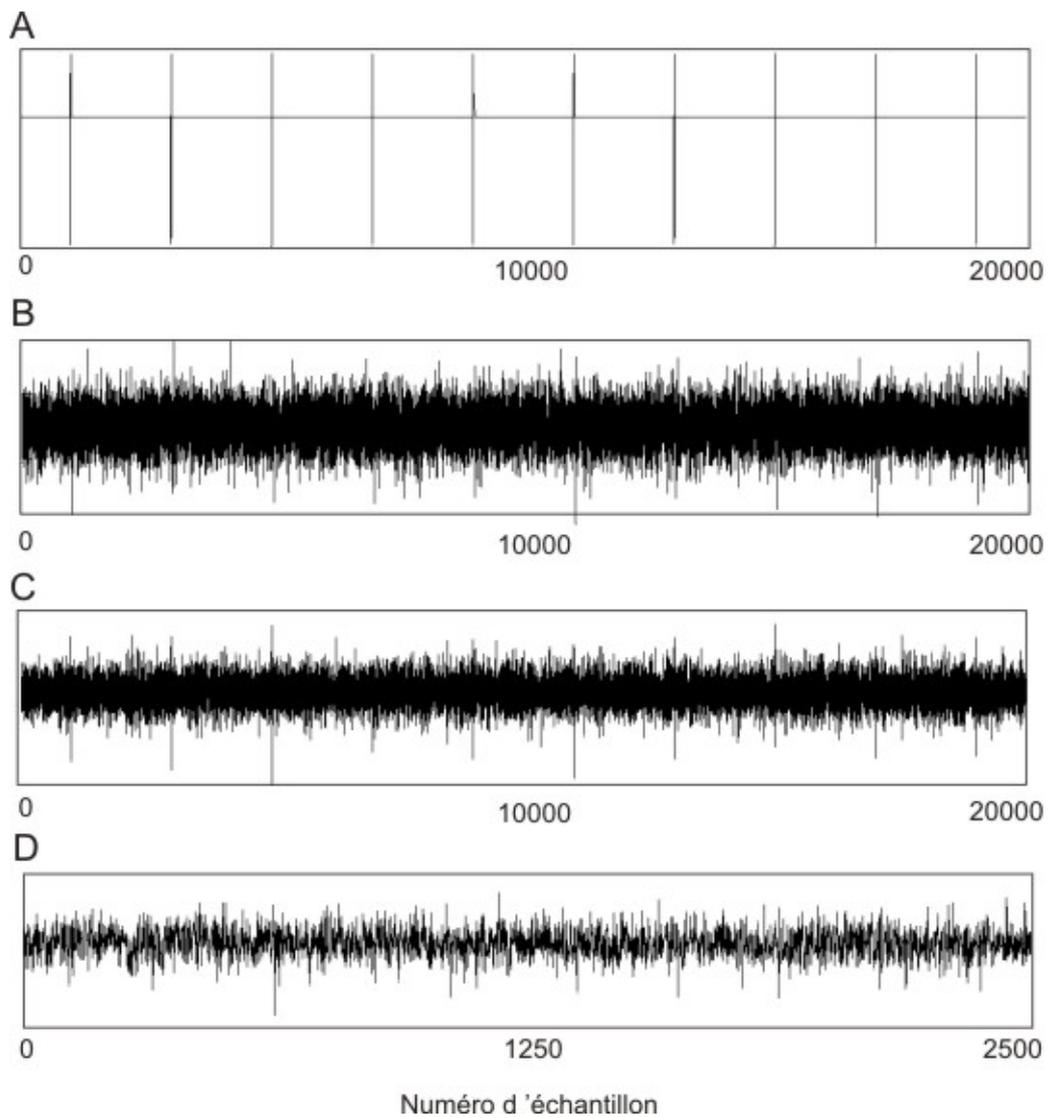
**Figure II.6** – Décomposition en ondelette d'un signal neuronal : A) Localisation des spikes, B) signal d'origine  $x[n]$ , C) troisième niveau de décomposition SWT  $d^3[n]$  et D) troisième niveau de décomposition DWT  $d^3[n]$ .
