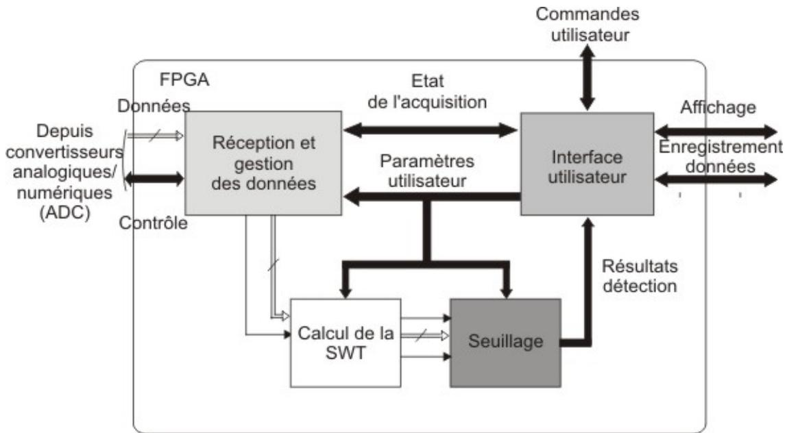
Figure III.1 – Architecture du système sur FPGA
