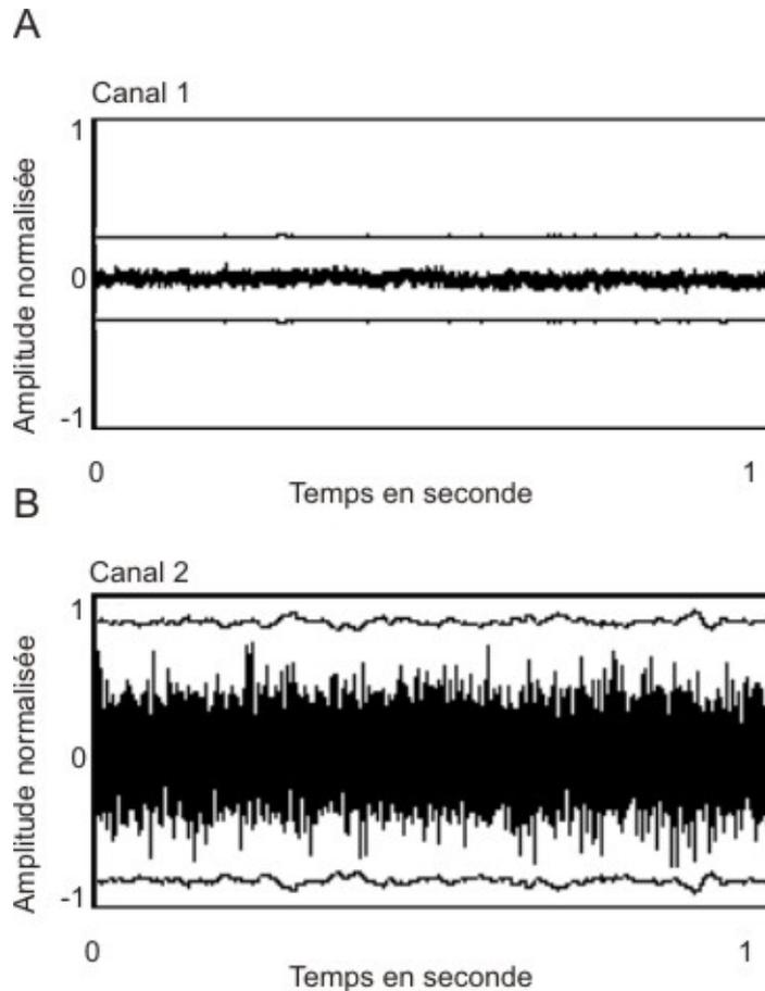
**Figure IV.13** – Seuil adaptatif : A) signal provenant d’un canal d’enregistrement de cellules pancréatiques primaires avec un niveau de bruit faible et son seuil, B) signal provenant d’un canal d’enregistrement de cellules pancréatiques primaires avec un niveau de bruit plus important et son seuil
