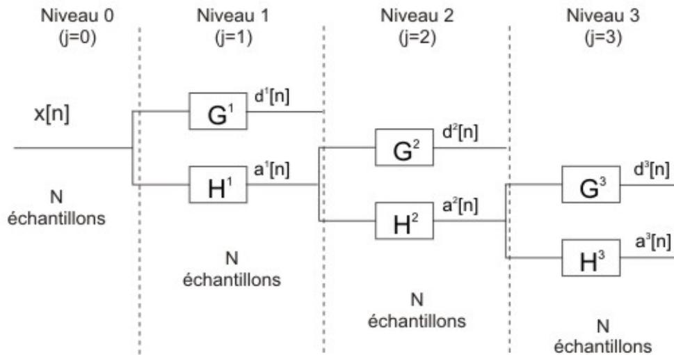
Sur - échantillonnage des coefficients des filtres
