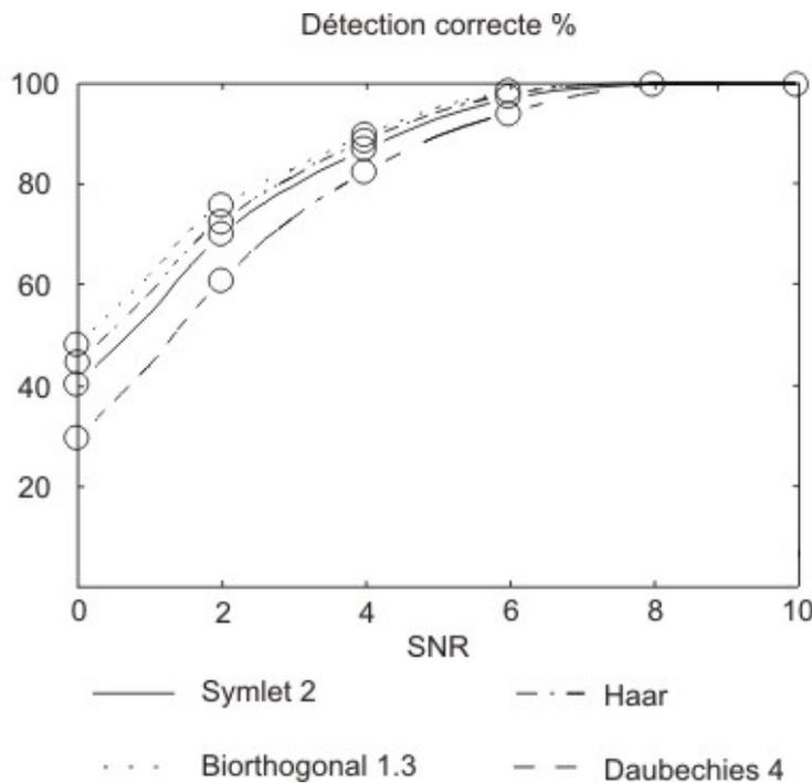
**Figure II.14** – Taux de détection pour différentes ondelettes mères sur un signal provenant des PAs *in vivo* de singe. La barre d'erreur maximale est de 0,99 % (non représentée) ; la valeur  $p$  et les faux positifs sont négligeables.
