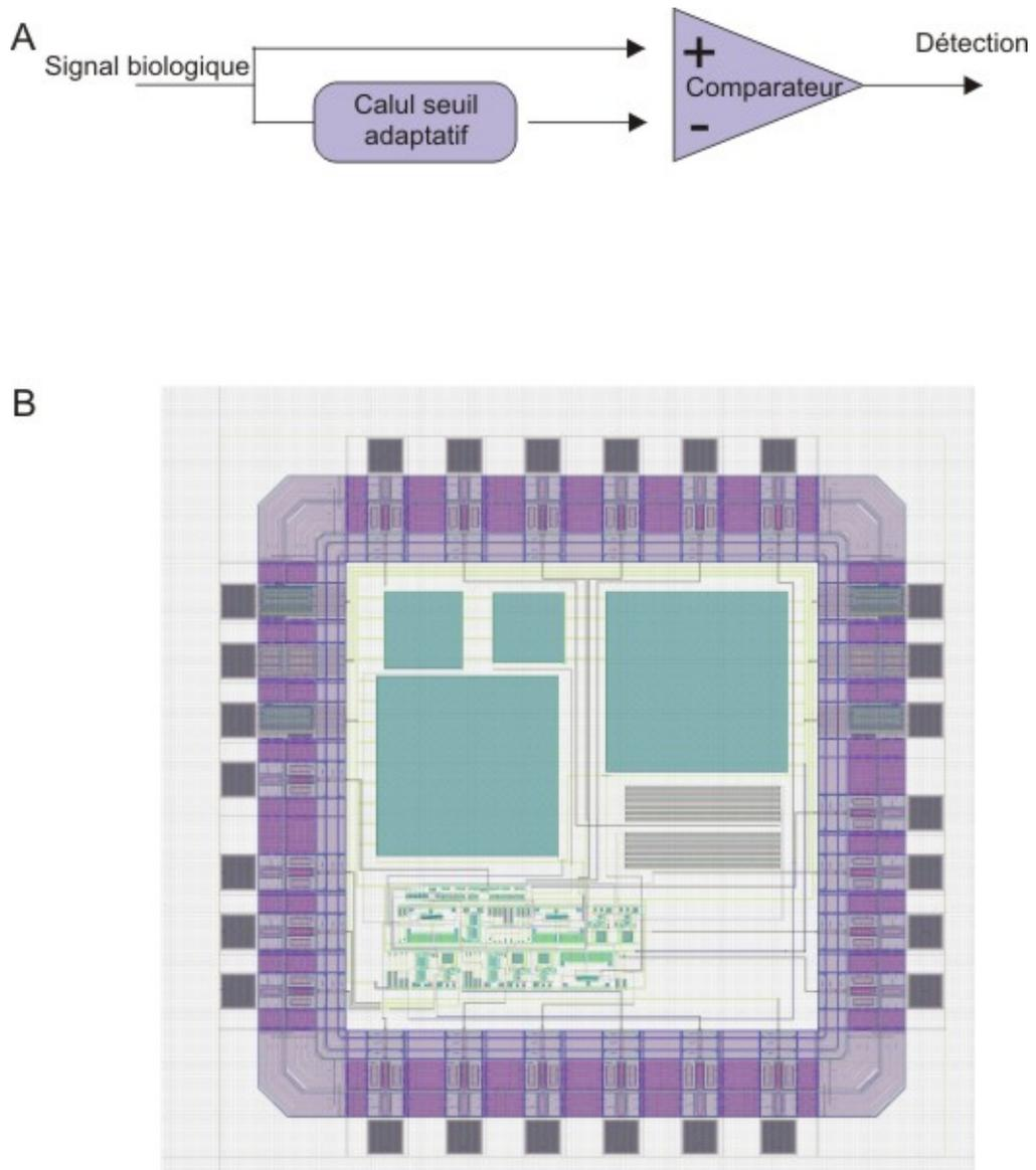
Figure I.17 – A) Schéma bloc du circuit intégré OSLO, B) Masques de fabrication du circuit intégré OSLO
