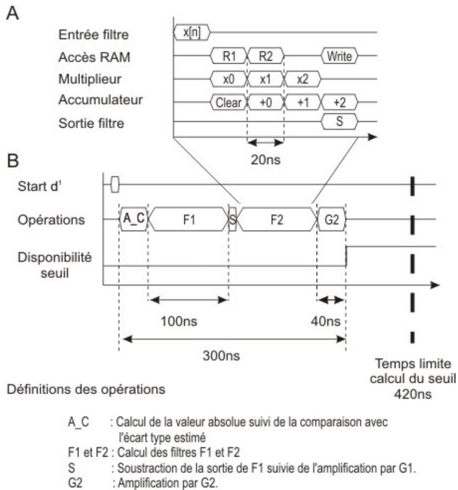
Figure III.10 – Chronogramme de test du calcul des filtres F1 et F2. A) Timing pour le calcul d'un filtre, B) Timing pour le calcul des deux filtres.
