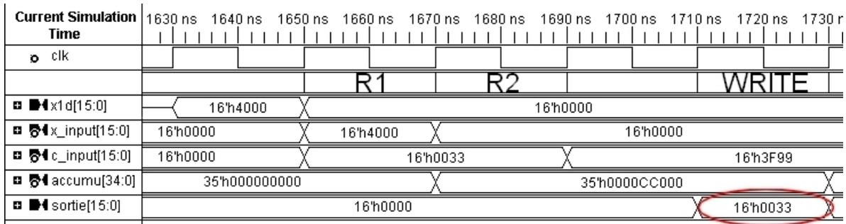
**Figure III.12** – Chronogramme de simulation du calcul du filtre F1. Ri correspond aux accès RAM de la figure III.10,  $x1d[15 : 0]$  : entrée du filtre,  $x\_input$  et  $c\_input$  : valeurs des RAMs  $x[n-1]$  ou  $y[n-1]$  et des coefficients,  $accumu[34 : 0]$  : valeur de l'accumulateur et  $sortie$  : résultat du filtre F1.
