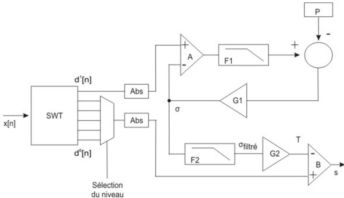
Figure II.7 – Bloc de détection en ondelette
