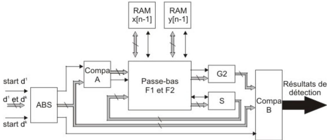
**Figure III.11** – Structure système finale du module de seuillage ; ABS : Calcul de la valeur absolue, Compa A et B : Compérateurs, G2 : Amplification par un gain G2 fixé par l'utilisateur ; S : Soustraction suivie d'une amplification par le gain G1.
