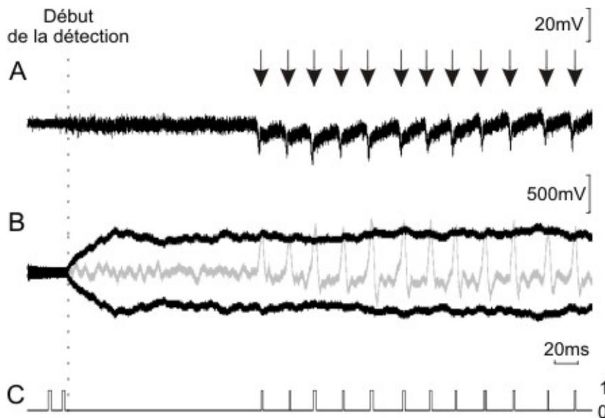
**Figure IV.7** – Sorties de NeuroBetaMed : A) signal pancréatique brut avec un haut SNR (SNR=9), B) sixième niveau de détail  $d^6$  de la SWT (gris) et son seuil adaptatif (noir) et C) sortie du circuit de détection. On remarque deux fausses détection en début de détection dû au retard d'établissement du seuil.
