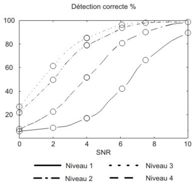
**Figure II.12** – Taux de détection pour différents niveaux de décomposition où le seuil est appliqué. Nous avons utilisé la SWT et l’ondelette mère Haar. La barre d’erreur maximale est de 0,93 % (non représentée) ; la valeur p (indiquant la probabilité que les résultats obtenus puissent être attribués au seul fait du hasard) et les faux positifs sont négligeables. ([Raoux et al., 2012])
