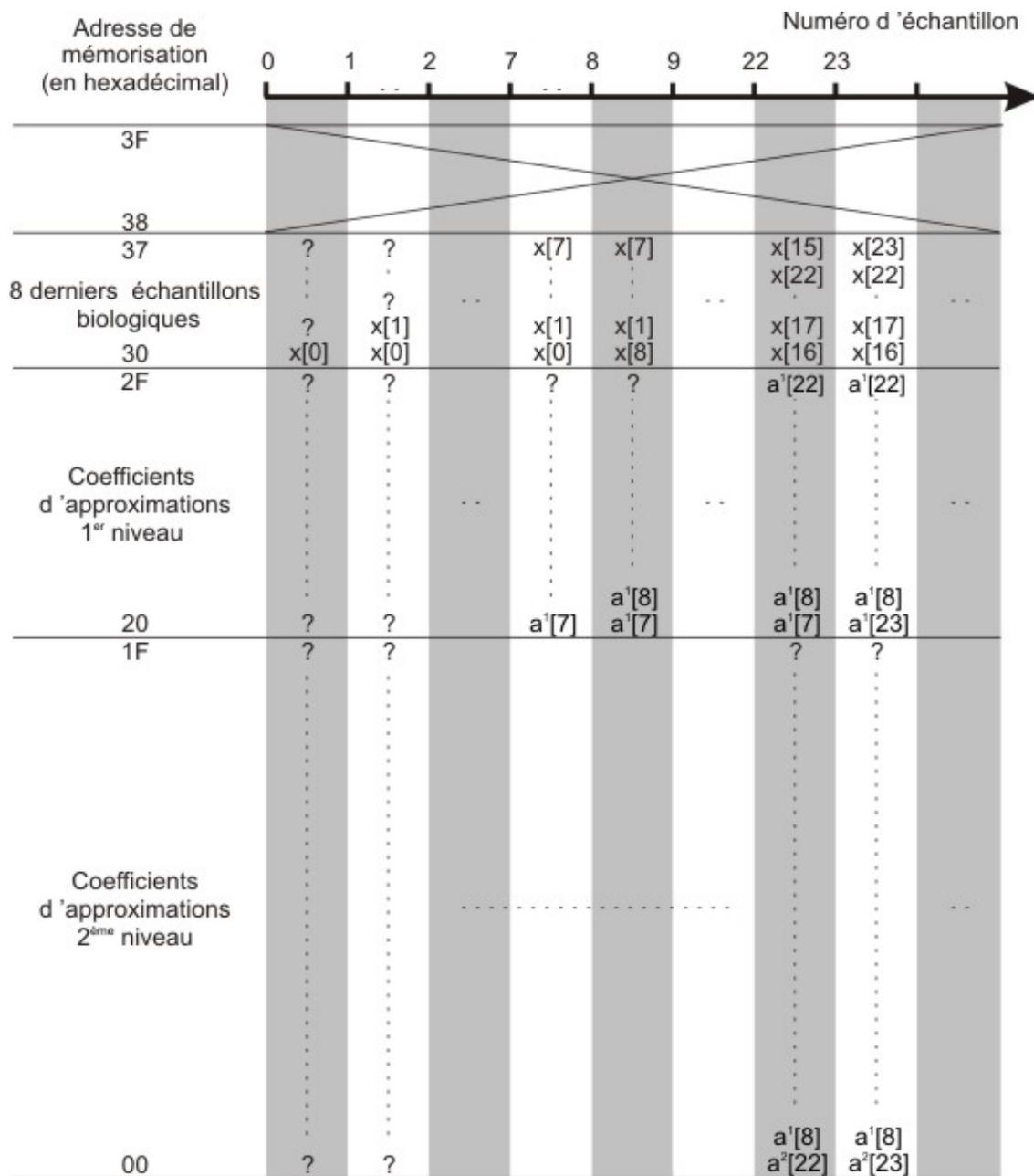
Figure III.4 – Evolution du remplissage de la mémoire RAM échantillons en fonction de l'arrivée d'un échantillon  $x[n]$ . La zone barrée (haut) correspond à la zone mémoire non utilisée. les ? représentent des espaces mémoires non encore affectés.
