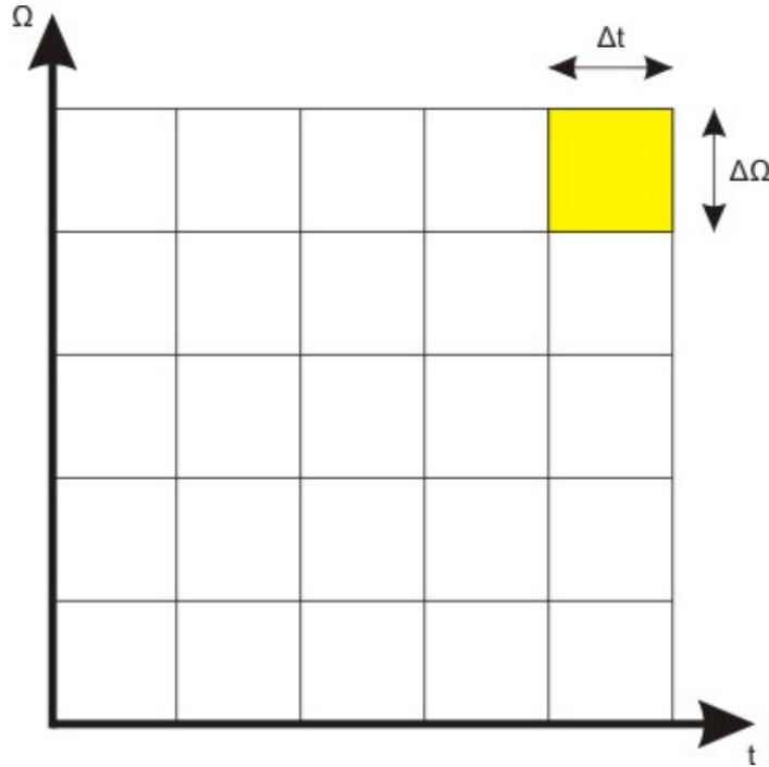
**Figure II.1** – Découpage en atomes temps-fréquence pour la STFT
