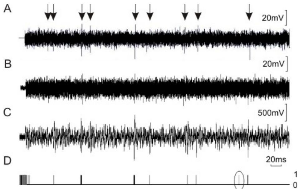
**Figure IV.8** – Sorties de NeuroBetaMed : A) signal pancréatique brut avec un haut SNR (SNR=7), B) signal pancréatique avec un bruit blanc gaussien ajouté, C) sixième niveau de détail  $d^6$  de la SWT et D) sortie du circuit de détection
