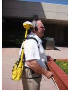
FIGURE 2.10 – Photographie du système PGS porté par un utilisateur non-voyant.
