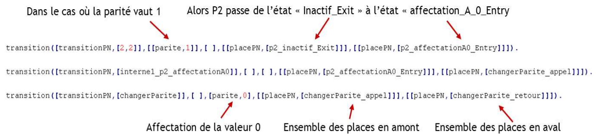
Figure 3.67: Transitions générées suite à la transformation automatique du modèle UML
