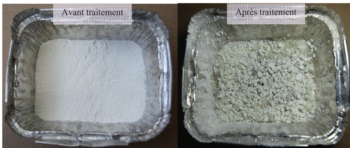
FIG. 2.4 – Photos de l'échantillon natif avant hydrotraitement et après traitement par DIC à la pression de 2 bar pendant 20 minutes de l'AMS.
