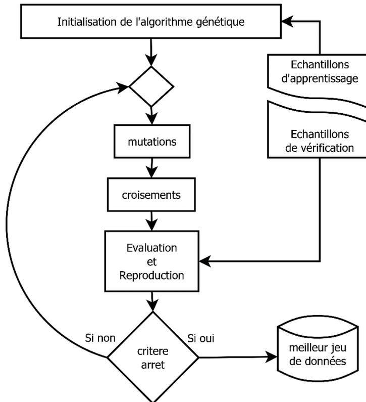
figure III.2 : Schéma d'exécution des Algorithmes Génétiques
