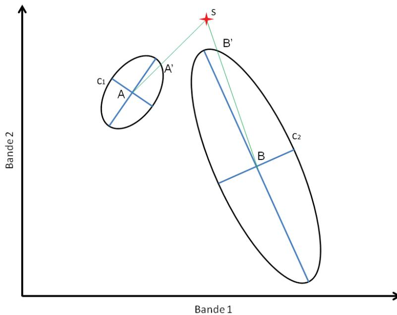
figure I.16 : Illustration de la nécessité de pondérer la distance euclidienne  $sA$  et  $sB$  par l'étendue de chaque classe (volume des ellipsoïdes). Le point  $s$  est plus proche de la classe  $c_2$ , d'où l'intérêt de la distance de Manahalobis ( $sA'$  et  $sB'$ )
