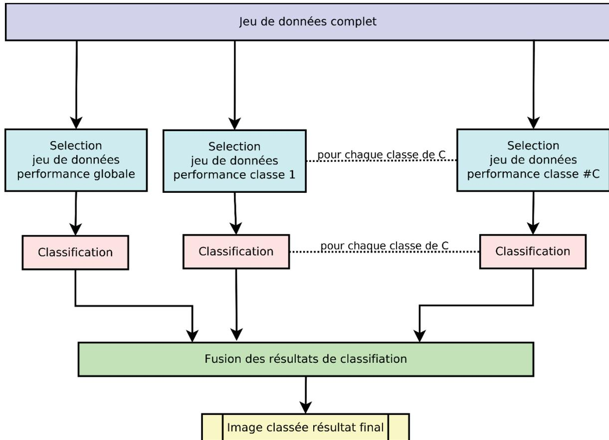
figure IV.6 : Illustration du processus de Sélection-Classification-Fusion
