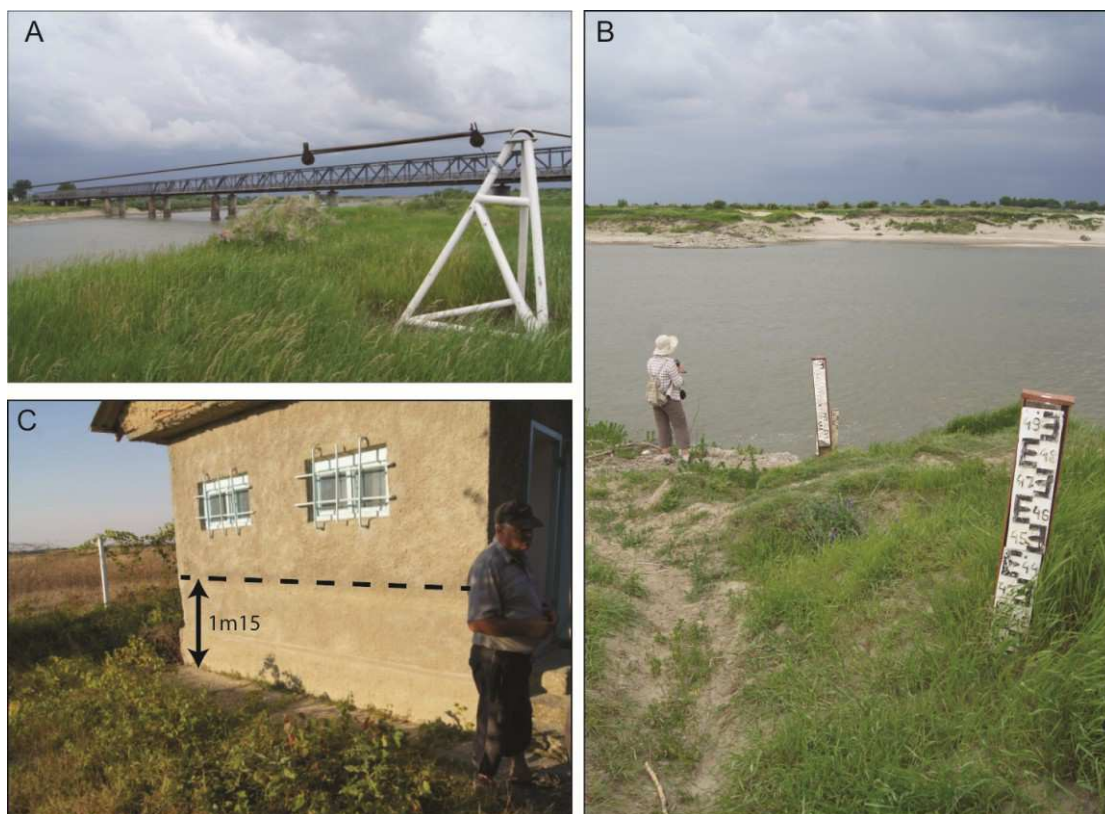
Figure 3- 4: A – Station hydrométrique de Lungoci (Siret), câble de mesure en juin 2011 et point de mesure de la section transversal, vu vers l’aval. B – Echelles limnimétriques en rive droite. C – Poste de la station de Lungoci en octobre 2011, avec une marque de la crue de juin 2010 sur la façade. (Photographies: F. Salit)
