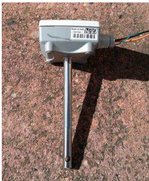
Figure 2.15 : Anémomètre à fil chaud et les emplacements aux hauteurs moyenne et haute derrière le métal déployé pour une lame d'air de 99mm
