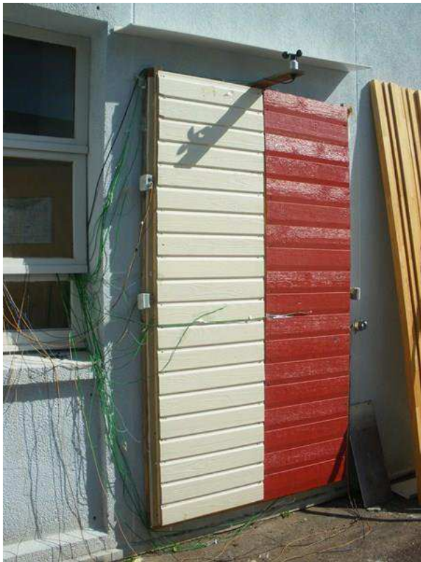
Figure 2.5 : Les deux bardages (pin brut-clair et pin aggloméré) sont placés.
