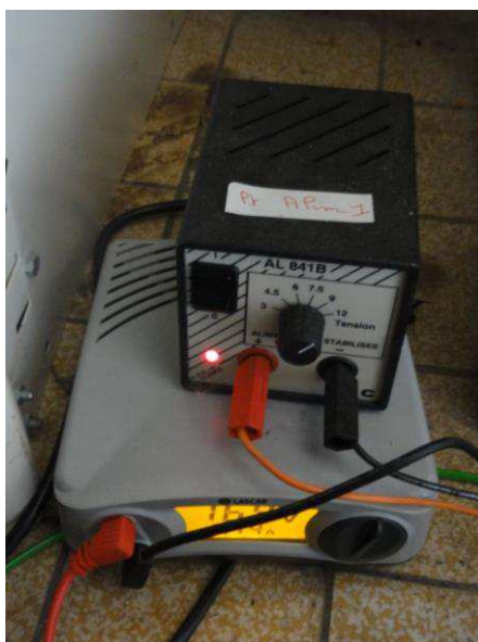
Figure 2.17 : Les deux générateurs basse tension utilisés
