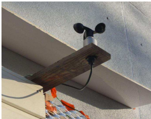
Figure 2.14 : Anémomètre à coupelle placé au-dessus du complexe EPLM
