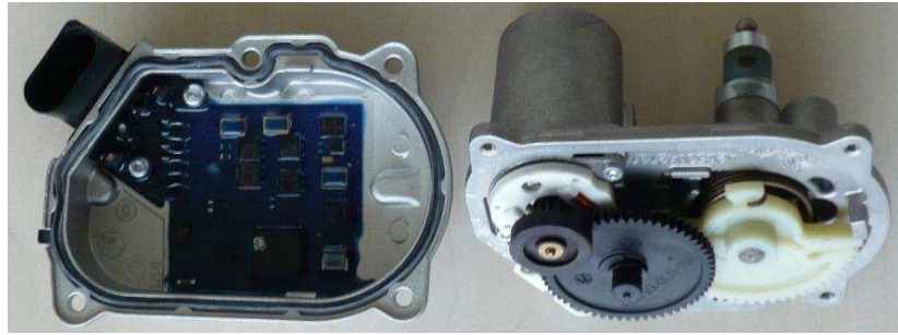
Figure 1-26 : Servomoteur Siemens VDO avec son électronique intégrée
