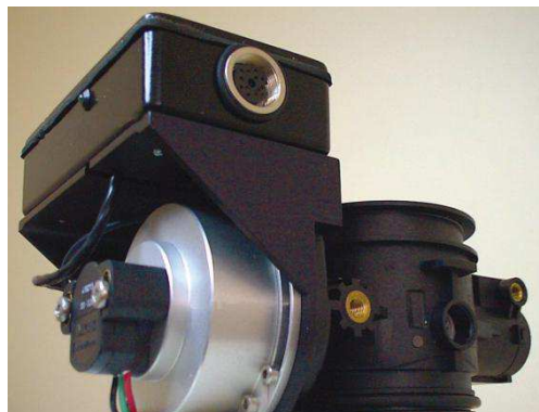
Figure 2-5 : Présentation du boîtier papillon à actionnement piézoélectrique source Telemaq [TEL-11]
