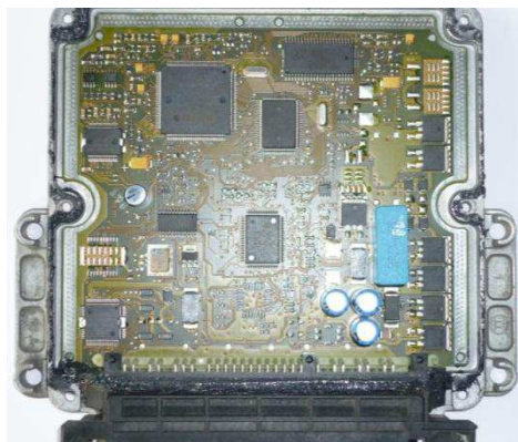
Figure 1-25 : Calculateur de gestion moteur Bosch EDC15 pour une application moteur 2.0HDI 90ch
