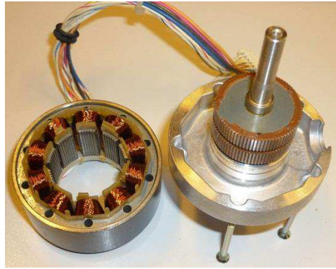
Figure 2-1 : Moteur pas à pas hybride Sanyo Denki à rotor aimanté et stator bobiné 5 phases
