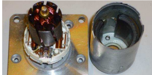
Figure 3-9 : MCC à nombre d'encoche impair et rotor torsadé et feuilleté
