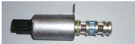
Figure 1-12 : Dispositif électrohydraulique de déphaseur d'arbre à came
