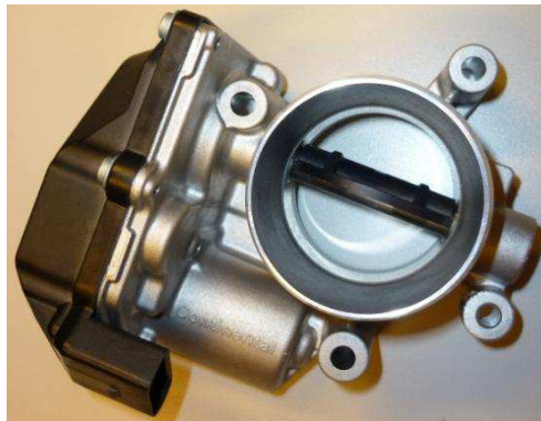
Figure 1-3 : Motoréducteur de volet étouffoir pour moteur diesel, Continental
