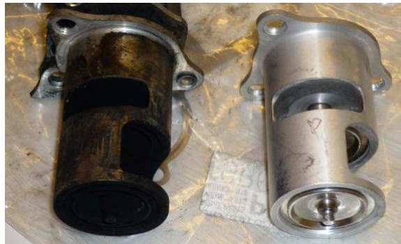
Figure 1-27 : Encrassement d'un obturateur à soupape équilibré d'une vanne EGR HP
