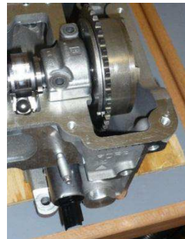
Figure 1-12 : Dispositif électrohydraulique de déphaseur d'arbre à came
