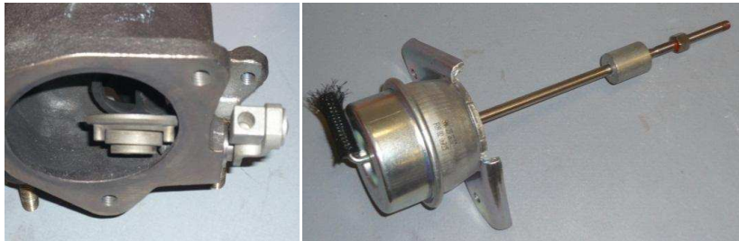
Figure 1-8 : Soupape de régulation de pression et son actionneur pneumatique
