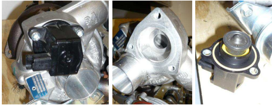
Figure 1-11 : Soupape de surpression située dans la volute du compresseur
