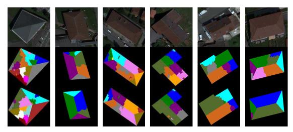
FIGURE 4.13 – Exemples de segmentations obtenues sans/avec le meilleur couple invariant/gradient. De haut en bas : l'image initiale, l'image segmentée sans invariant et l'image segmentée avec le couple Greyworld/Di-zenzo.
