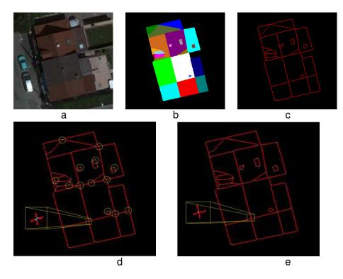
FIGURE 5.12 – Modèles obtenus sans et avec l'étape de jointure de points de jonction. (a) imagette de toiture à caractériser, (b) vérité terrain correspondante, (c) image de frontières, (d) modèle obtenu sans l'étape de jointure de points de jonction et (e) modèle obtenu avec cette étape de jointure.
