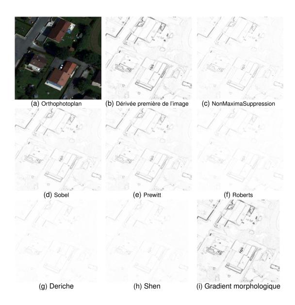
FIGURE 4.3 – Illustration de différents gradients niveaux de gris.
