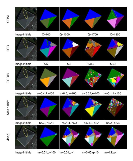
FIGURE 6.18 – Illustration de la mauvaise qualité des arêtes détectées par les algorithmes de segmentation testés (CSC, EGBIS, MeanShfit et Jseg).
