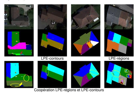
FIGURE 6.9 – Illustration des images pour lesquelles la segmentation produite par notre approche est moins satisfaisante que celle réalisée avec la LPE-contours (les images des trois premières colonnes) ou la LPE-régions (l'image de la dernière colonne).
