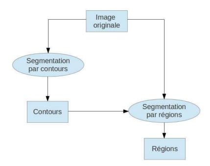
FIGURE 6.1 – Principe de la coopération séquentielle [Sebari 2007].
