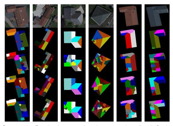
FIGURE 4.11 – Exemples de segmentations obtenues avec le gradient de Prewitt, sans/avec l'utilisation de l'invariant HSL. De haut en bas : l'image initiale, les images segmentées avec les composantes HSL-Z, RGB-X, RGB-Y, et RGB-Z.
