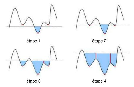
FIGURE 3.4 – LPE-Les différentes étapes d'inondation d'un relief. Les minimas locaux du relief (points rouges) représentent les sources d'inondation. La ligne grise est la hauteur d'inondation, et les lignes verticales rouges, représentent les barrages entre les différentes sources.
