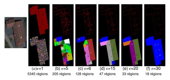
FIGURE 5.16 – Influence du paramètre  $\epsilon$  dans la segmentation par LPE-contours. De haut en bas : l'image en sortie de la LPE-contours associée à une valeur de  $\epsilon$  donnée et l'image de régions correspondante.
