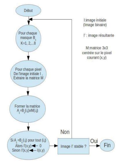
FIGURE 5.4 – Algorithme de squelettisation [Tonye 2000].
