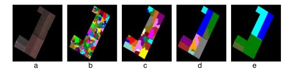
FIGURE 4.6 – Exemple de réduction de germes (a) l'image initiale ; les images segmentées avec (b) tous les minima locaux (168 régions) ; (c)  $\alpha$ =1,  $\beta$ =5 (40 régions) ; (d)  $\alpha$ =10,  $\beta$ =15 (14 régions) ; (e)  $\alpha$ =10,  $\beta$ =80 (sous-segmentation avec 6 régions seulement).
