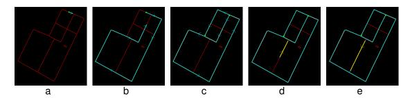
FIGURE 5.6 – Principe de la création des segments : Illustration de quelque cas possibles. (a) et (d) choix arbitraire d'un point de départ, (b) choix du meilleur point suivant, (c) et (e) le point à ajouter coïncide avec un point déjà référencé : le sens du parcours est alors inversé.
