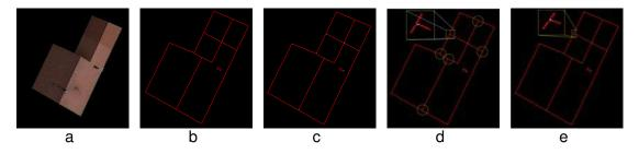
FIGURE 5.9 – Amélioration du modèle 2D de la toiture par l'ajout de points de tolérance. (a) image initiale, (b) image de frontières, (c) modèle 2D obtenu sans subdivision de segments, (d) modèle 2D obtenu sans ajout de points de tolérance, (e) modèle 2D obtenu avec ajout de points de tolérance.
