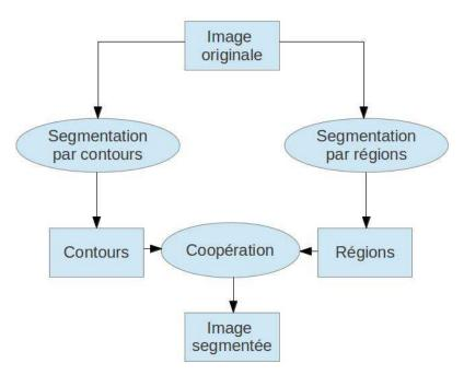
FIGURE 6.2 – Principe de la coopération des résultats [Sebari 2007].
