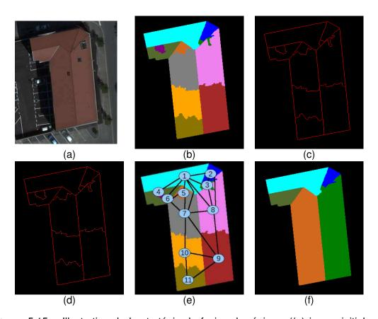
FIGURE 5.15 – Illustration de la stratégie de fusion de régions. ((a) image initiale, (b) image pré-segmentée par LPE, (c) extraction des frontières, (d) modèle 2D caractérisant la toiture, (e) RAG de l'image pré-segmentée, (f) segmentation finale.
