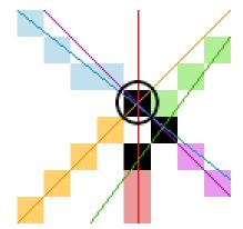
Position du point de jonction calculée en fonction des équations des segments composés par les points du même groupe
