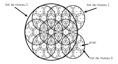
FIGURE 3.1 – Algorithme CSC: Structure hiérarchique hexagonale. [Baillie 2003]
