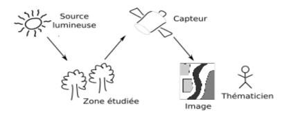
FIGURE 2.1 – Principe de base de la télédétection. [Kurtz 2008]
