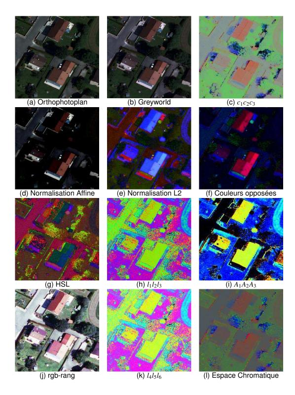
FIGURE 4.1 – Orthophotoplan avec application de différents invariants colorimétriques.
