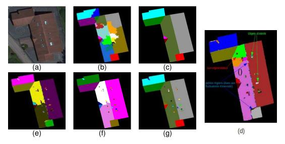
FIGURE 6.6 – Etapes clés du processus de coopération. (a) la toiture à segmenter, (b) image segmentée par LPE-régions seule, (c) image obtenue après fusion de régions (l'image étiquetée A sur la figure 6.5), (d) image segmentée par LPE-contours (l'image étiquetée B), (e) l'image étiquetée C, (f) l'image étiquetée D et (g) segmentation finale.
