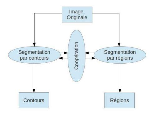
FIGURE 6.3 – Principe de la coopération mutuelle [Sebari 2007].
