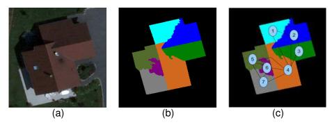
FIGURE 5.14 – Exemple de RAG d'une image segmentée. (a) imagette de toiture, (b) image présegmentée par LPE et (c) graphe d'adjacence de régions correspondant.
