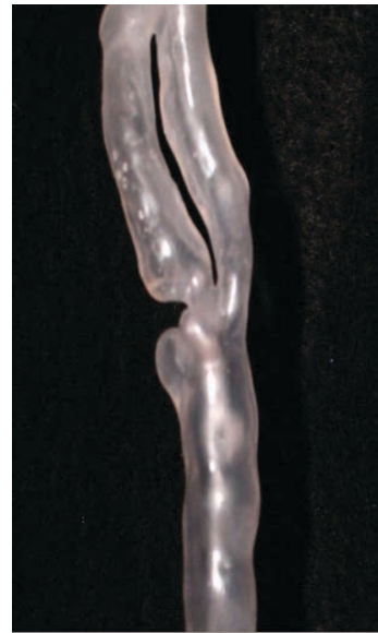
(b) Fantôme de carotide de sténose en silicone
