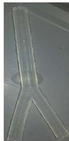
FIGURE 2.37 – Modèle des Fantômes de carotide en forme Y
