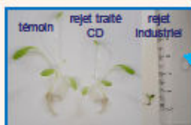
Figure 4 : Rejets de traitement de surface traités par bioadsorption [technique en mode cuvée : 100 mg polymère, 100 mL effluent, 1 h agitation; photométrie et AA four/flamme]
