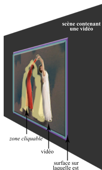
figure. 4.36 - La zone cliquable est une forme transparente placée devant l'élément de média «vidéo»
