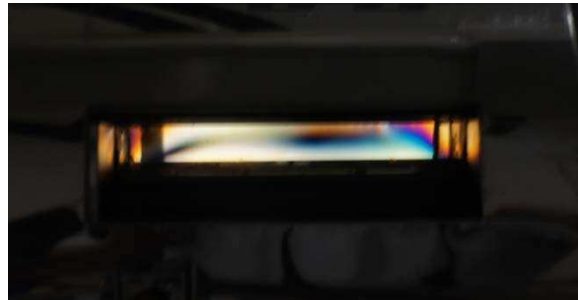
Figure 100: Exemple de la présence de concentration de contraintes dans la fenêtre en verre.
