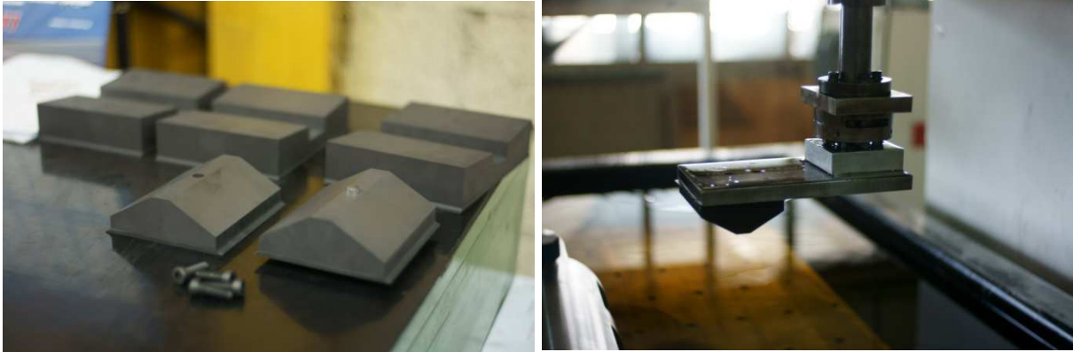
Figure 74 : Différentes électrodes de finition pour l'électroérosion des trois emplacements des fenêtres en verre et montage d'une électrode de finition sur la machine d'électroérosion.
