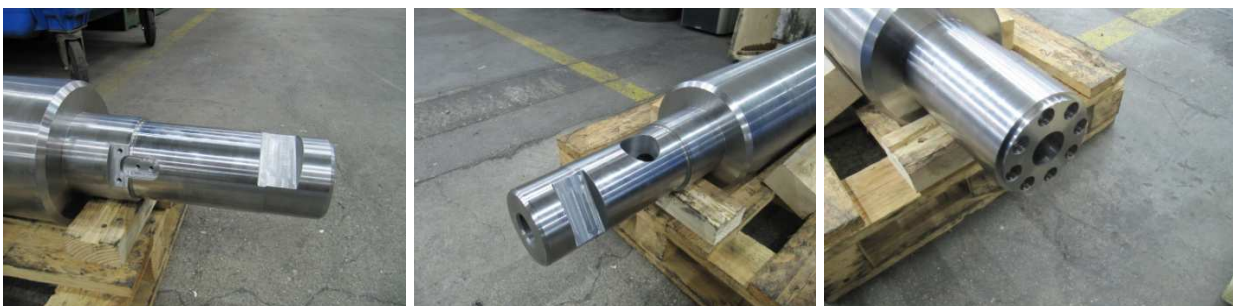
Figure 71 : Extrémités du fourreau à la fin d'usinage
