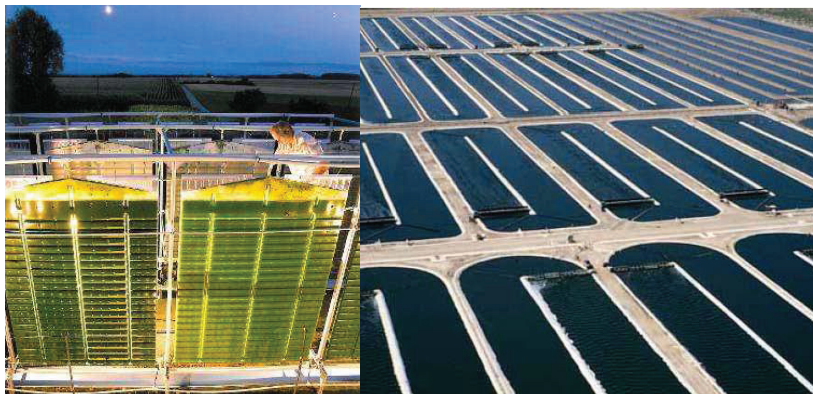
Fig. I. 10 – Système de culture de type photobioréacteur (PBR) et « raceway » [15]
