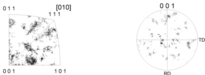
Figure IV-16 : Relations d'orientation des paquets de lattes de la zone A.
