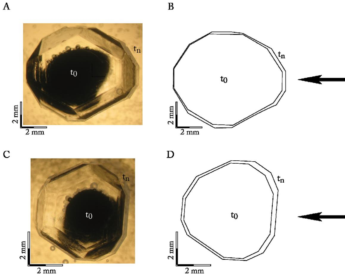
Figure 3. 3. Photos de cristaux de K-alun poussant dans une solution sursaturée dynamique (A et C) et dessins correspondant montrant les épaisseurs des bandes de croissances (B et D, respectivement).  $t_0$  et  $t_n$  sont respectivement l'état initial et final du cristal. Les flèches indiquent le sens de circulation du fluide. Noter la différence d'épaisseur entre les faces amont et aval.
