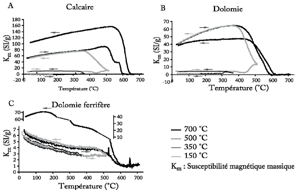
Figure 4. 9. Evolution de la susceptibilité magnétique massique  $K_m$  en fonction de la température dans le calcaire (A), la dolomie (B) et la dolomie ferrifère (C). Les flèches montrent le sens d'évolution de la température (chauffe ou refroidissement).
