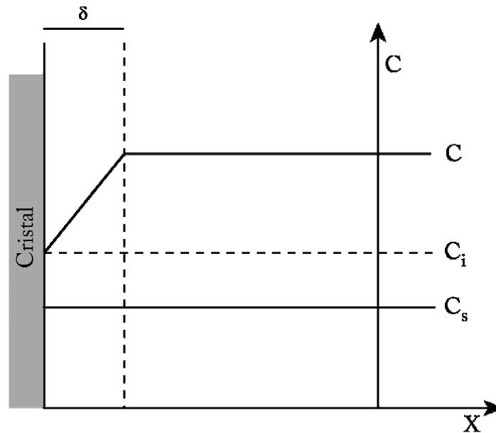
Figure 2. 6. Profil de concentration autour d'un cristal dans le modèle du film (dans Klein et al., 1989).  $\delta$  est l'épaisseur de la couche limite,  $C_i$  est la concentration à l'interface,  $C_s$  est la concentration à l'équilibre,  $C$  est la concentration moyenne de la solution.  $C-C_i$  est la force motrice de transfert de matière et  $C_i-C_s$  est la sursaturation à l'interface.
