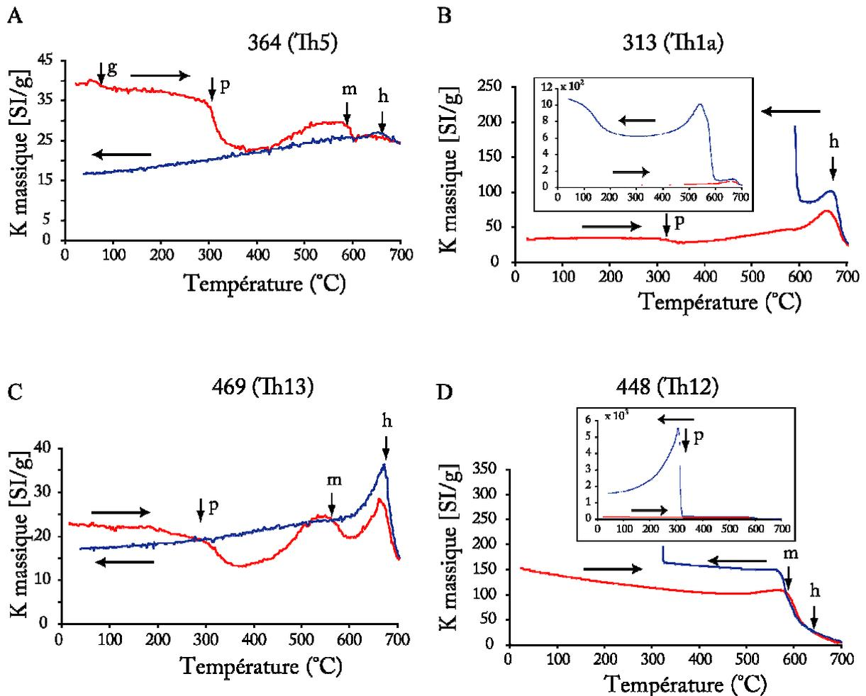
Figure 6. 8. Evolution de la susceptibilité magnétique massique  $K_m$  en fonction de la température. (A), (B) et (C) échantillons pris dans le gossan à profondeur croissante ; (D) : amas sulfuré. Les flèches horizontales indiquent les sens d'évolution de la température, et les flèches verticales montrent les différentes  $T_c$  (g : goethite, h : hématite, p : pyrrhoite et m : magnétite ou titanomagnétite).
