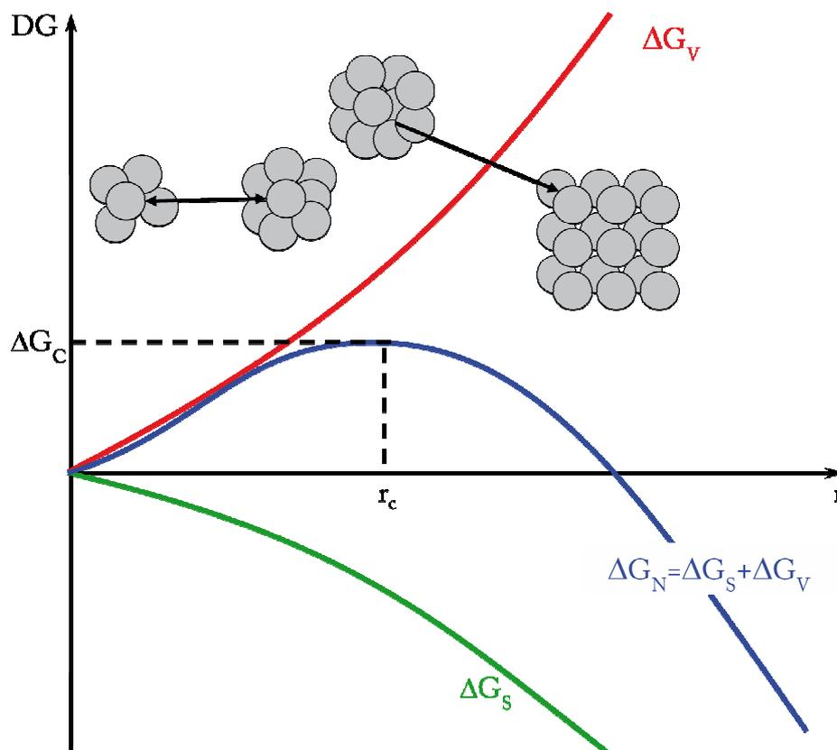
Figure 2. 1. Evolution de l'enthalpie libre lors d'une nucléation primaire.  $\Delta G_V$  : énergie de volume,  $\Delta G_S$  : énergie de surface,  $\Delta G_N$  : somme des deux grandeurs,  $\Delta G_V$  et  $\Delta G_S$ ,  $\Delta G_C$  : c'est la  $\Delta G_N$  maximale (Dans Papon et al., 2002 et [www.inp-toulouse.fr](http://www.inp-toulouse.fr)).
