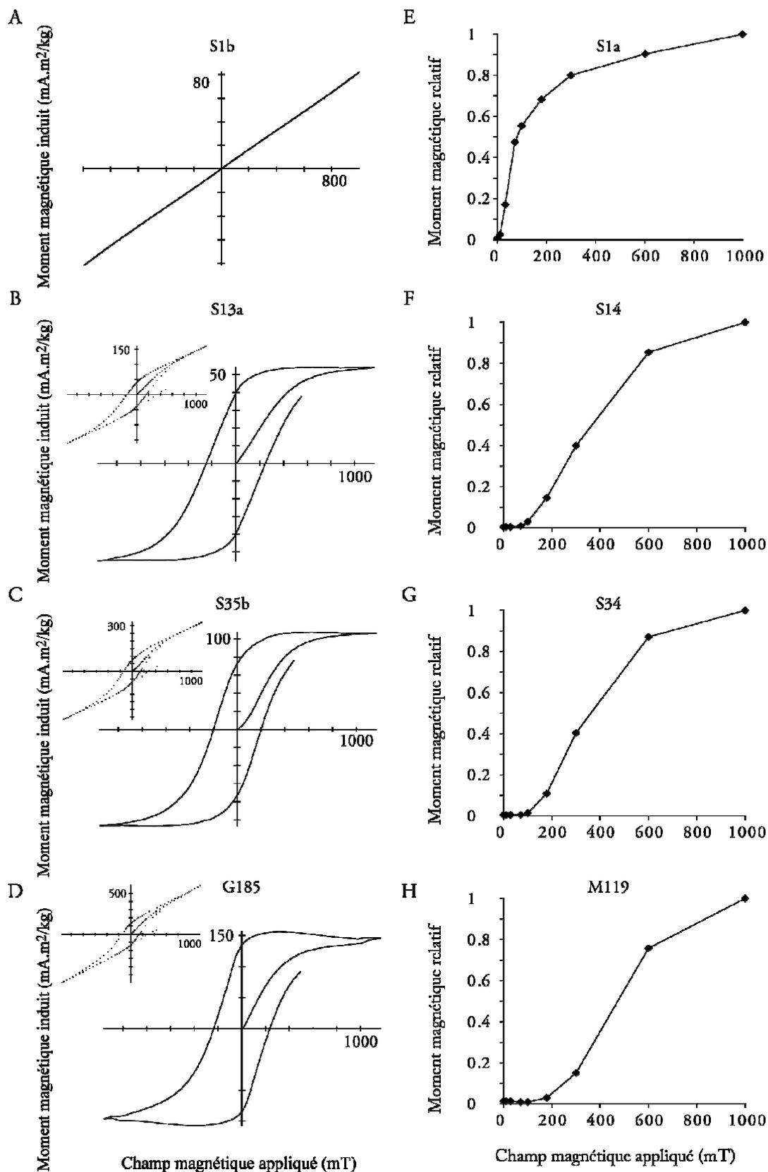
Figure 6. 17. Cycles d'hystérésis (gauche) et d'ARI (droite) pour des échantillons provenant de l'amas (A et E) et des gossans (B, C, D, F, G et H).
