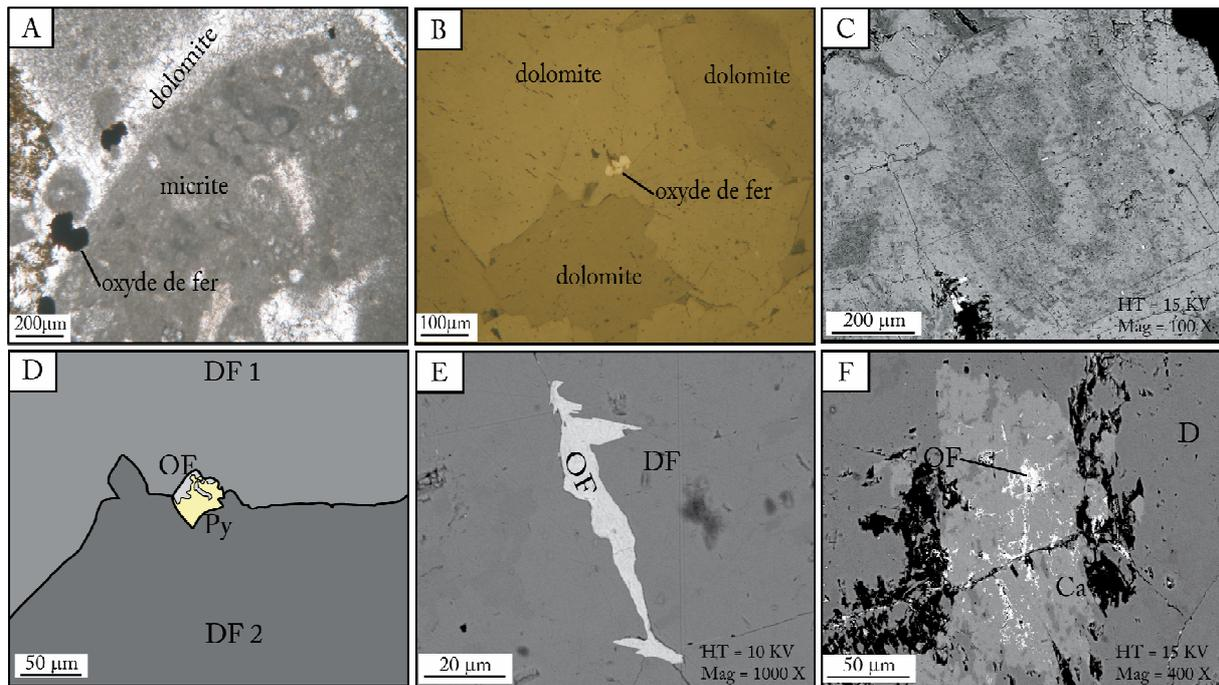
Figure 4. 4. Photographies montrant la pétrographie des trois lithologies encaissant la minéralisation ainsi que les oxydes de fer observés dans les lames de dolomie ferrifère. A. calcaire, B. dolomie, les photos sont prises au microscope pétrographique. C à F : dolomie ferrifère. C, E et F sont des photos MEB (électrons rétrodiffusés) alors que D représente un schéma d'une structure observée au MEB. Ca : calcite ; D : dolomite, DF : dolomite ferrifère ; OF : oxyde de fer ; Py : pyrite.
