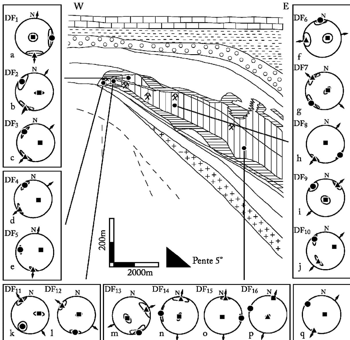
Figure 4. 14. Projections stéréographiques des directions principales de l'ellipsoïde de l'ASM pour la dolomie ferrifère. Les ellipses représentent les intervalles de confiance à 95%. (■ :  $K_1$ , ▲ :  $K_2$  et ● :  $K_3$ ). La projection est faite dans l'hémisphère inférieure. Le stéréogramme q montre la projection de la moyenne de tous les sites de dolomie ferrifère.
