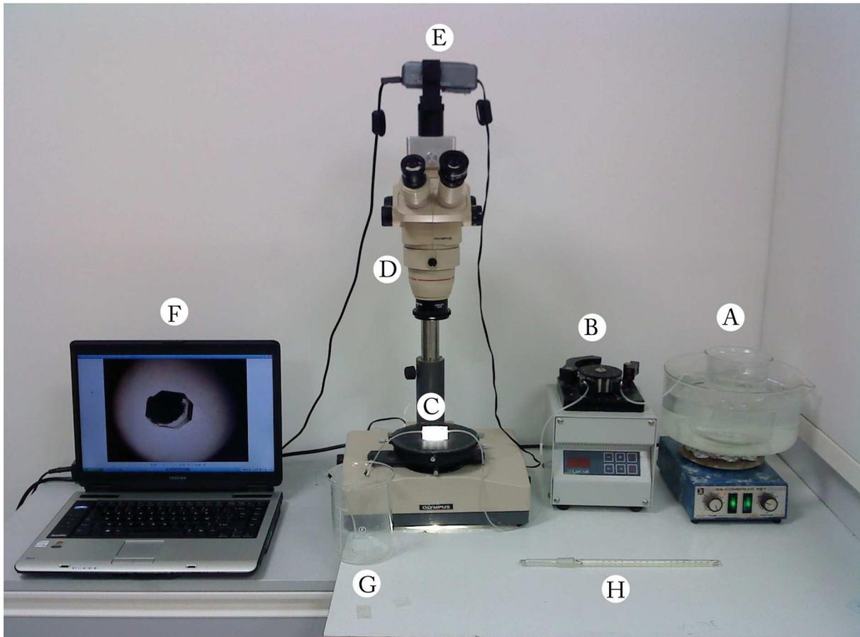
Figure 3. 1. Dispositif expérimental utilisé afin d'étudier la croissance de cristaux de K-alun dans un fluide en mouvement. La signification des lettres est donnée dans le texte.
