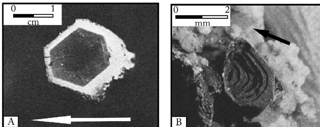
Figure 2. 8. Observation des cristaux grandissant dans un fluide en circulation. (A) section perpendiculaire à l'axe  $\langle c \rangle$  d'un quartz transparent (gris) entouré d'un quartz translucide (blanc) observée par Newhouse (1941). (B) Cristal de galène observé par Kessler (1972). Les flèches indiquent le sens de circulation du fluide.
