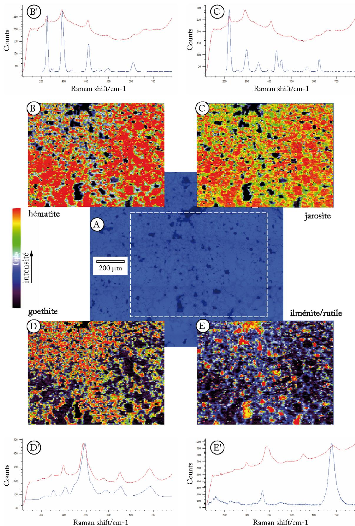
*Figure 6. 5. Cartographie Raman (analysée statistiquement par DCLS Cf. Chapitre 1 pour la définition) dans le gossan (A ; échantillon 313 de Tharsis). (B), (C), (D) et (E) représentent les cartes de répartition des phases minéralogiques (le maximum d'intensité est en rouge), tandis que (B'), (C'), (D') et (E') représentent une comparaison entre les spectres des zones à maximum d'intensité (rouge) et les spectres de référence (bleu).*
