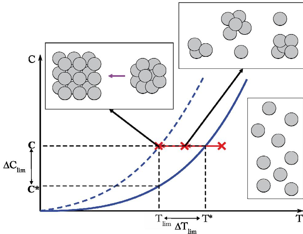
Figure 2. 2. Evolution de la courbe de concentration en fonction de la température lors d'une nucléation primaire (dans Klein et al., 1989 et [www.inp-toulouse.fr](http://www.inp-toulouse.fr)). On passe d'une solution sous-saturée à une sursaturée en baissant la température. Voir la signification des variables dans le texte.
