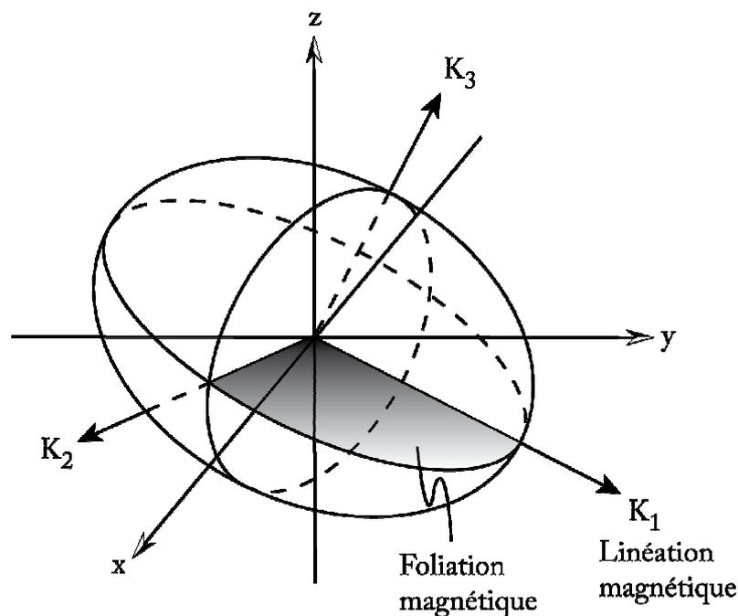
Figure 1. 2. Ellipsoïde de susceptibilité magnétique (Tarling et Hrouda, 1993).
