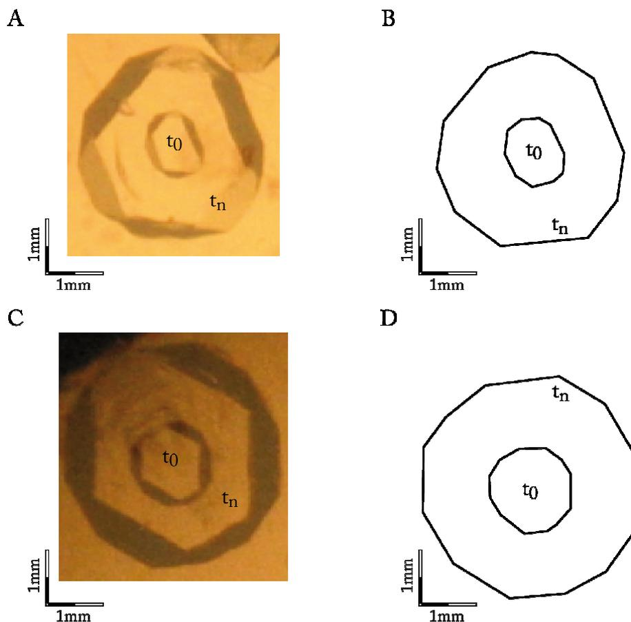
Figure 3. 2. Photos de cristaux de K-alun poussant dans une solution sursaturée statique (A et C) et dessins correspondant (B et D, respectivement).  $t_0$  et  $t_n$  sont respectivement l'état initial et final du cristal. Noter les épaisseurs équivalentes des bandes de croissance autour des cristaux.
