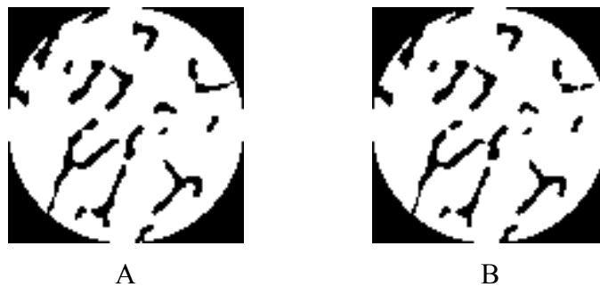
Figure III.36: Exemple d'une coupe transversale d'une image \mu\text{IRM} segmentée par la méthode d'étiquetage (cf. III.5.1) (A) et par seuillage simple (B).
