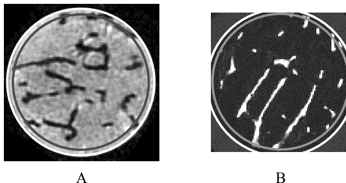
Figure III.14: Illustration de la ROI sur les coupes transversales d'un échantillon pour les images \mu IRM après repositionnement (A) et SR- \mu CT après dégradation (B). Les cercles blancs correspondent à l'ajustement de l'enveloppe cylindrique pour les deux modalités (par la méthode présentée en III.4.2.1): les rayons de ces deux cercles sont identiques (ce qui traduit l'égalité des résolutions entre les deux images). Les cercles gris sont les ROI sur lesquelles est effectuée la recherche de la ROI commune. Ils sont définis par le même rayon (en voxels): celui du plus grand cercle inclus dans l'échantillon pour l'image SR- \mu CT D . Par contre, les hauteurs des cylindres sont propres à chaque modalité du fait de la différence de champ de vue (cf. III.3.1.4 et III.3.2.3).
