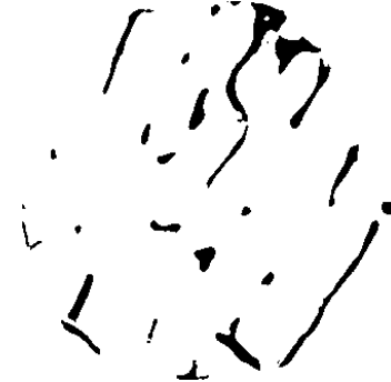
Figure III.22: Exemple de segmentation d'une coupe transversale d'une image SR- \mu CT. La convention choisie pour la représentation est la même que celle des images \mu IRM: les niveaux de gris 0 et 255 sont affectés respectivement à la phase calcifiée et à l'espace des pores (cf. Figure III.21).
