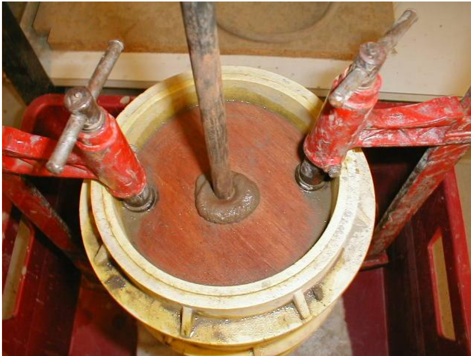
figure 2-15, observation de la consistance du limon au retrait de la sonde expérimentale de perméabilité
