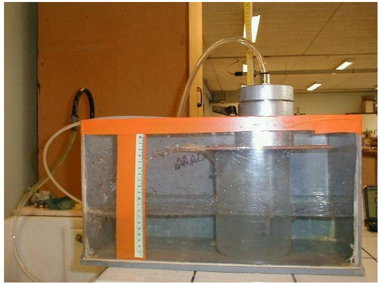
figure 2-7, vues du dispositif d' étalonnage de la sonde
