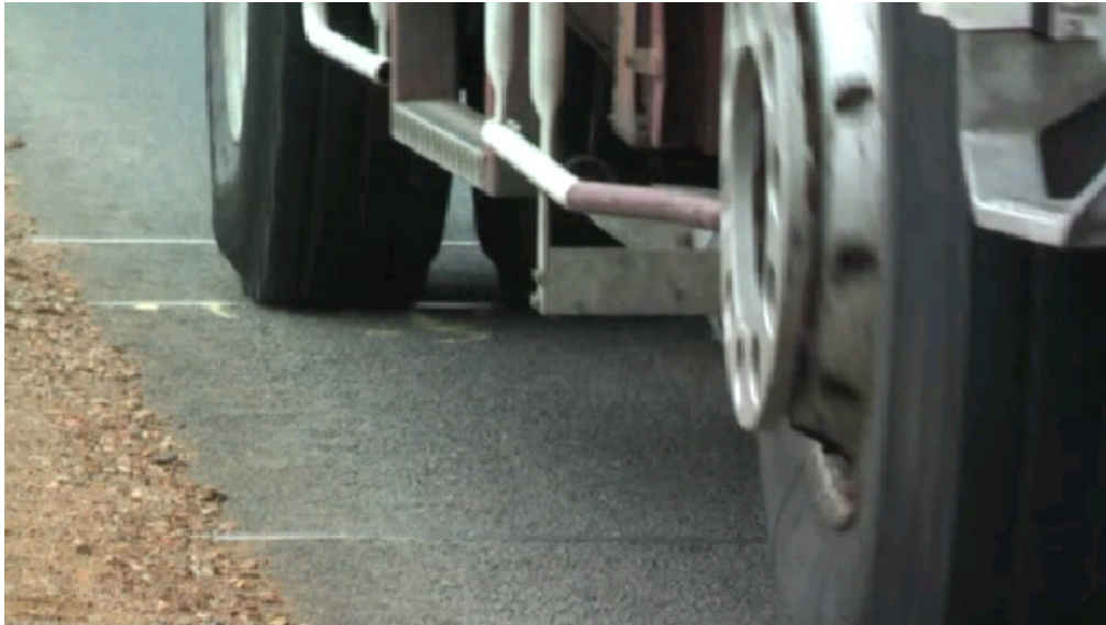
FIGURE 10.20 – Passage 1 - Image extraite de la vidéo représentant l'essieu arrière sur le capteur à fibres optiques.
