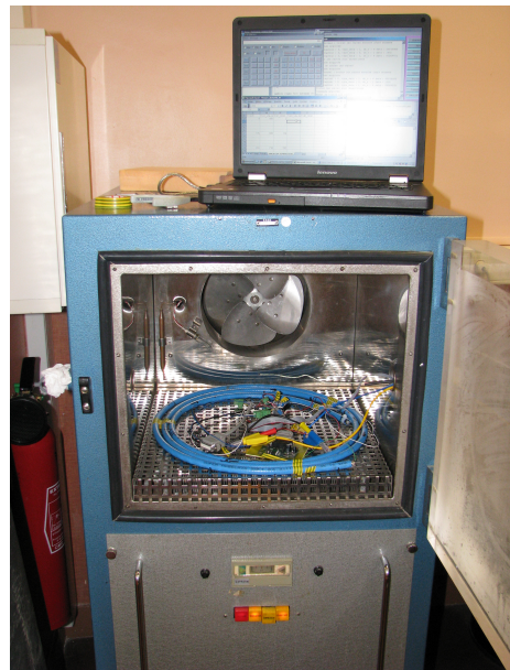
FIGURE 8.21 – Présentation de la manipulation : le capteur et son électronique sont dans l'étuve.
