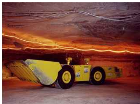
FIGURE 4.23 – Guidage par un fil lumineux d'un véhicule minier de 50 tonnes.
