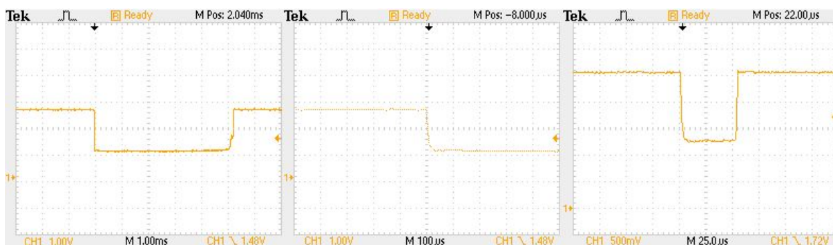
FIGURE 11.8 – Temps de réponse mécanique du capteur résistif conditionné dans de la résine mesuré à l'aide d'un oscilloscope numérique avec à gauche une sollicitation réalisée par une massette, au centre un zoom sur la transition descendante et à droite une sollicitation réalisée avec un maillet.
