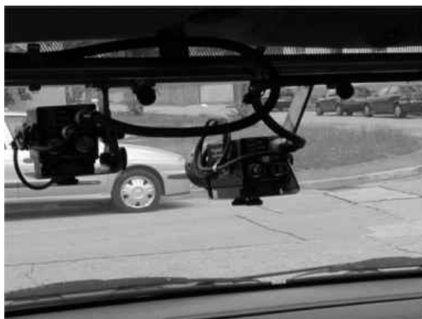
FIGURE 4.1 – Une disposition possible d'un système vidéo, ici à l'avant du véhicule.
