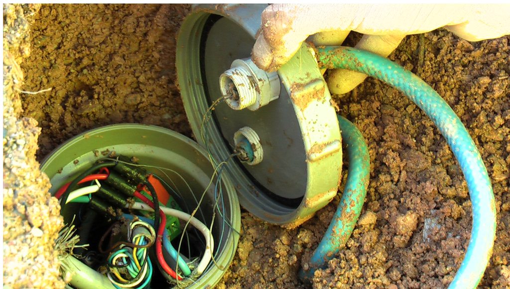
FIGURE E.8 – Photographie d'une remontée du tube en PVC contenant un noeud (carte électronique), les câbles électriques et deux arrivées de capteur (deux tuyaux traversant le couvercle, en bleu).
