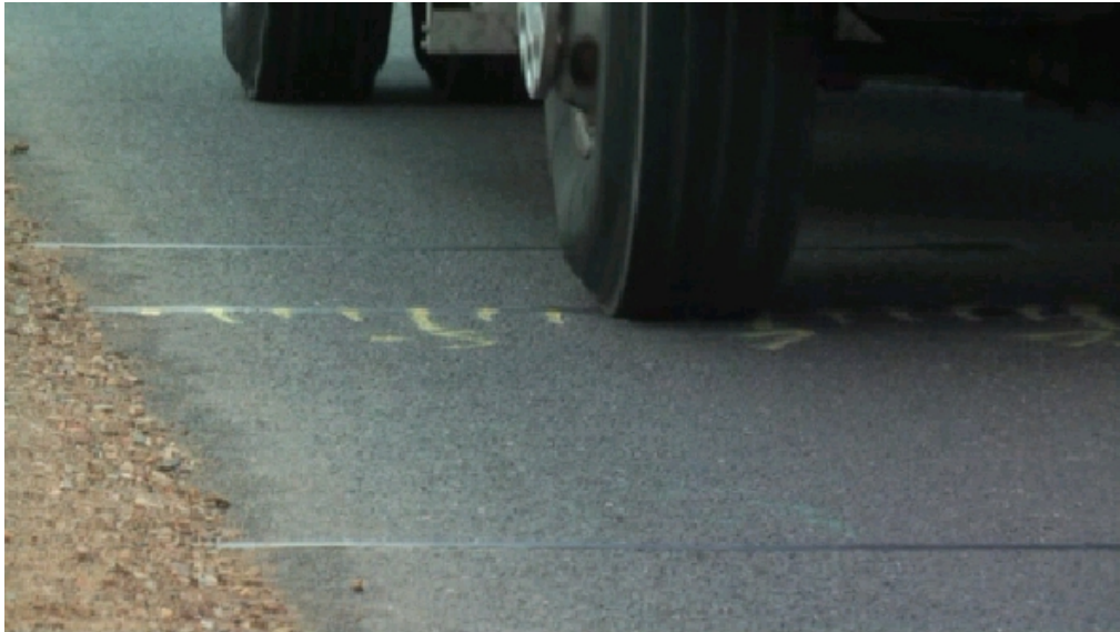
FIGURE D.21 – Passage 5 - Image extraite de la vidéo montrant le pneu avant droit sur le capteur à fibres optiques.
