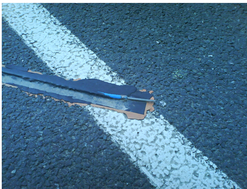
FIGURE E.9 – Allongement du capteur suite à de nombreux passages.
