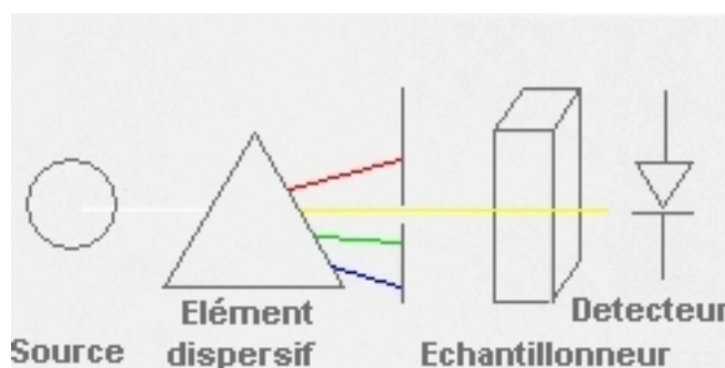
FIGURE B.2 – Echantillonnage de la longueur d'onde après un prisme.
