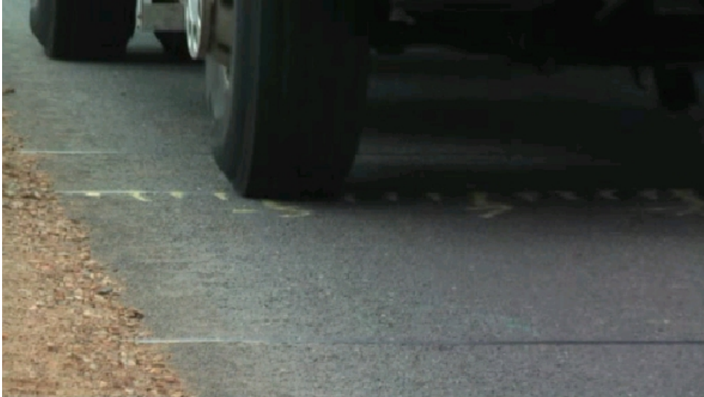
FIGURE 10.15 – Passage 1 - Image extraite de la vidéo montrant le pneu avant droit sur le capteur à fibres optiques.
