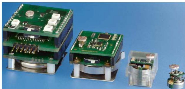
FIGURE 2.1 – Evolution des WSN autonomes de 1 à 0.025 cm 3 (feuille de route de Fraunhofer IZM) [1]
