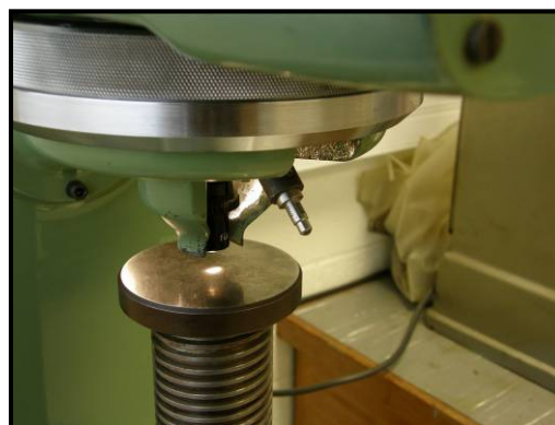
Figure 3.20 : Photographie du dispositif expérimental d'essai Brinell
