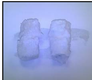
Figure 3.23 : Figure : Cristaux obtenus durant la saturation dans la solution de 3\text{Na}^+ + \text{PO}_4^{3-} (procédé 1)
