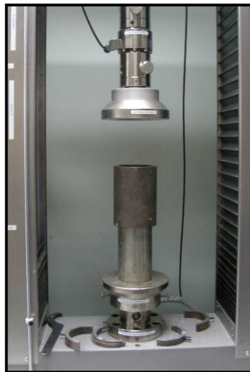
Figure 4.17 : Démoulage d'une éprouvette à l'aide d'un contre-piston
