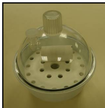
Figure 2.32 : Echantillon sous cloche à humidité relative contrôlée
