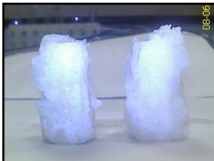
Figure 3.23 : Figure : Cristaux obtenus durant la saturation dans la solution de 3\text{Na}^+ + \text{PO}_4^{3-} (procédé 1)
