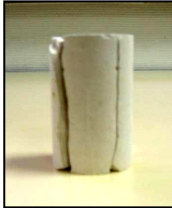
Figure 2.22 : Photo d'un échantillon de craie après rupture en compression uniaxiale
