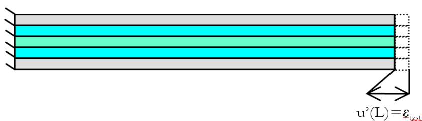
Figure 66 : conditions limites d'un stratifié encastree-libre
