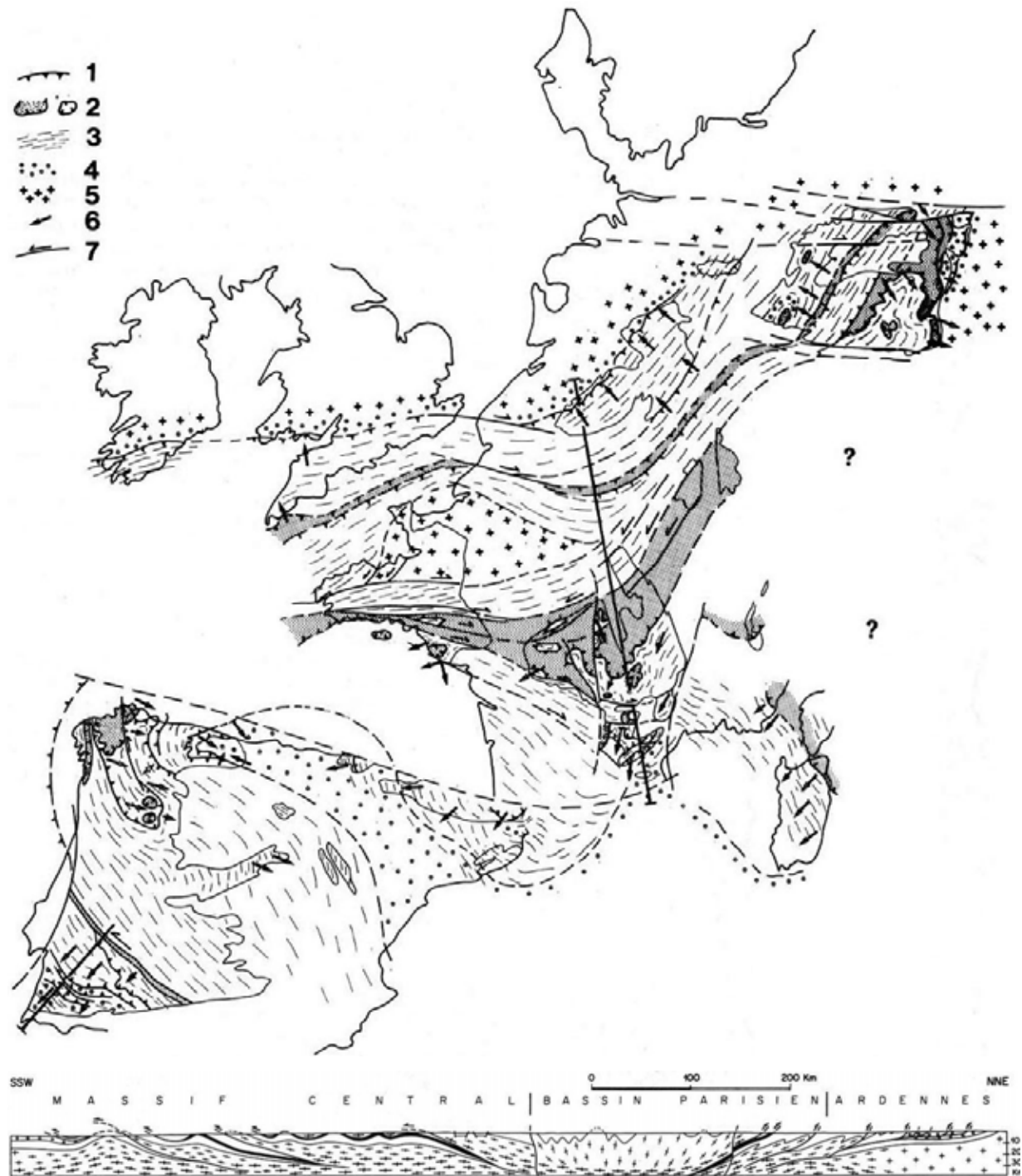
Figure I.2 : Carte structurale de la chaîne Varisque Ouest Européenne et coupe N-S des Ardennes au Sud du Massif Central, d'après Matte (1986) 1) principaux chevauchements ; 2) nappes cristallines internes et sutures ophiolitiques ; 3) domaines à schistosité de flux ou foliation ; 4) bassins dévono-carbonifères externes ; 5) plates-formes ou blocs avec peu ou pas de déformation hercynienne ; 6) sens de transport des nappes et déversement des grands plis couchés ; 7) grands décrochements ductiles.
