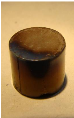
Figure 88 : Photographie du comprimé de nickel (E3) après chauffage sous argon. Surface supérieure localement noircie sous l'effet du plasma.
