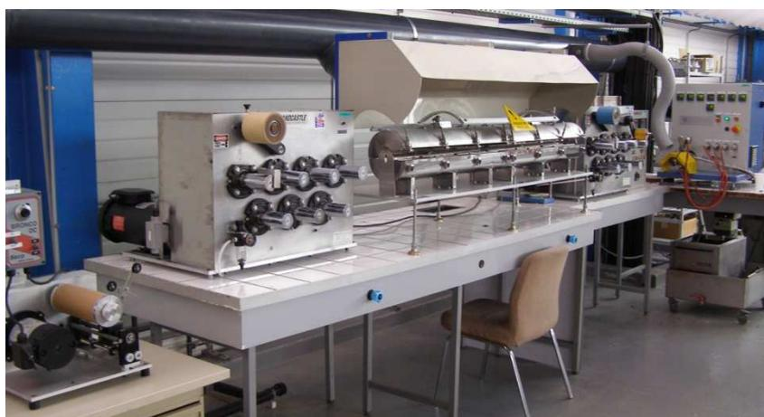
*Figure I-27 : Machine de filage par voie fondue [105]*
