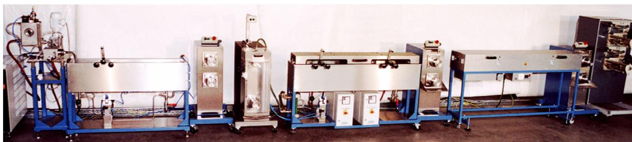
*Ligne de filage en continu de fibres multifilaments obtenues en voie solvant. (photo société FOURNÉ Polymertechnik GmbH).*
