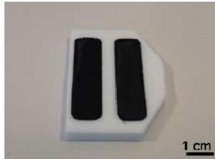
*Figure V-1 : Photographie d'un moule en téflon dans lequel deux films composites à base de PVA et de nanotubes de carbone sont en train de sécher.*
