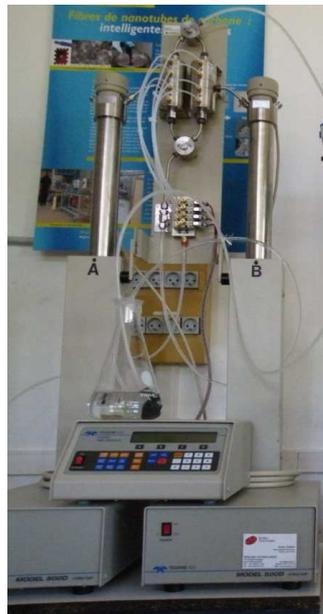
**Figure III-14 :** Pompe à piston Teledyne ISCO modèle 500D utilisée pour l'injection de la solution aqueuse de nanotube de carbone, Brij®78 et PVA.
