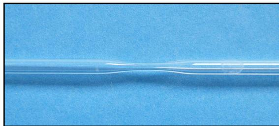
**Figure II-3 :** Photo d'un morceau de conduite en verre présentant une réduction de diamètre de  $d_1=2,4\text{mm}$  à  $d_2=1,5\text{mm}$  sur une distance de 6mm, suivi d'un élargissement pour revenir au diamètre de conduite initial.
